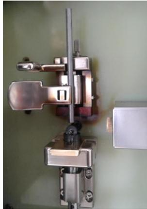
Figura 17. Varilla de grafito con rodamiento de grafito y black cup con muestra de aceite lubricante.
