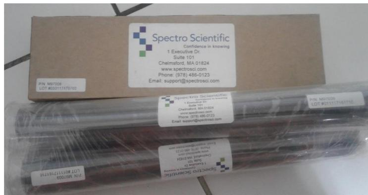
Anexo 6.1 VARILLAS DE GRAFITO PARA EL ESPECTROFOTÓMETRO DE EMISIÓN ATÓMICA SPECTROIL Q100.
