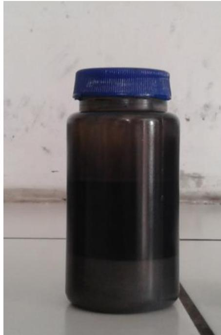
Anexo 8.1. MUESTRA DE ACEITE LUBRICANTE CON METALES DE DESGASTE PRECIPITADO.
