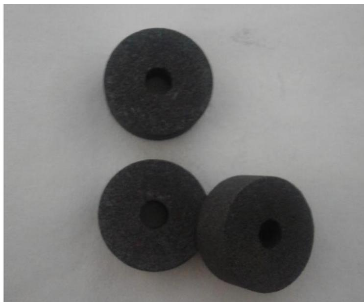
Anexo 6.2 RODAMIENTOS DE GRAFITO PARA EL ESPECTROFOTÓMETRO DE EMISIÓN ATÓMICA SPECTROIL Q100.
