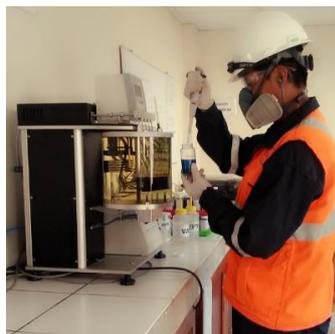
Figura 14. Análisis de aceite lubricante en el viscosímetro
