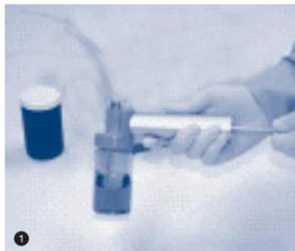
Figura 8. Extracción de muestra de aceite lubricante (ExxonMobil, 2017).
