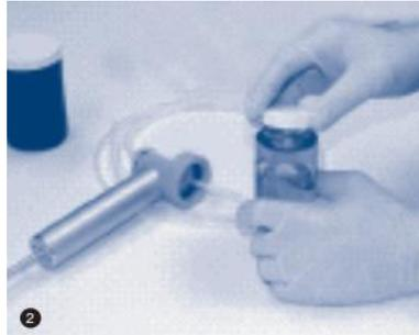
Figura 9. Cerrado de frasco de muestra de aceite lubricante (ExxonMobil, 2017).
