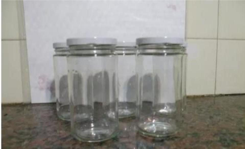
**Figura 7.** Frascos de vidrio de boca ancha de (1000 mL).
