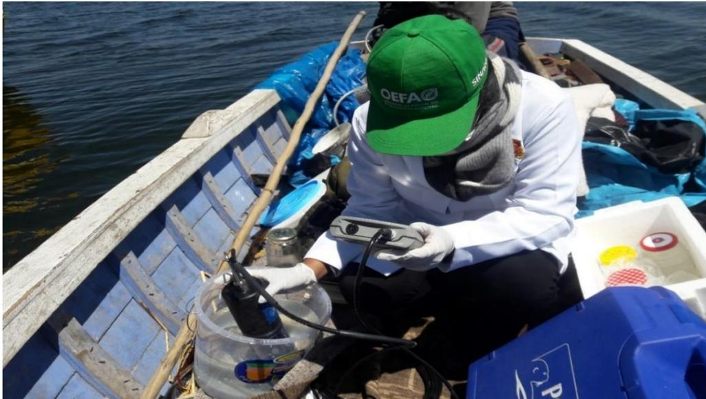
**Figura 35.** Lectura “in situ” de parámetros con multiparamétrico.
