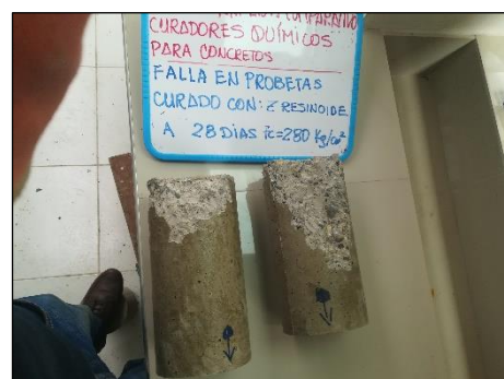
Figura 51: Tipo de falla en probetas curadas con Z Resinoide.
