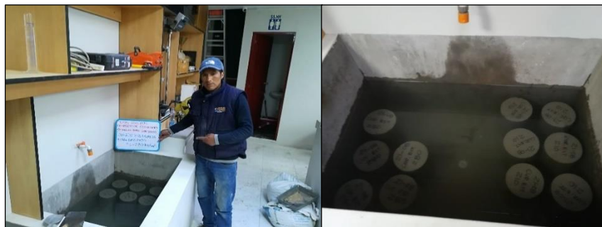
Figura 38: Curado de cilindros de concreto en poza estandarizada.
