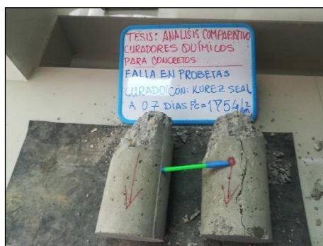
Figura 50: Tipo de falla en probetas curadas con Kurez Seal.
