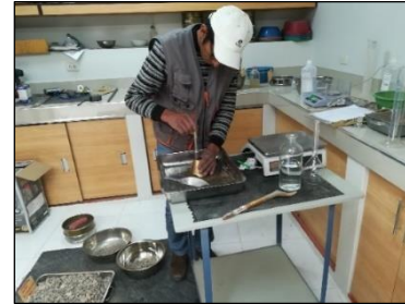
Figura 19: Suministro de agua destilada en el Picnómetro.
