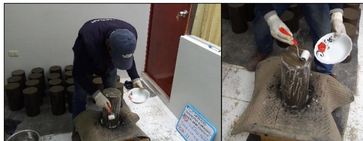
Figura 42: Curado de probetas con Sika Cem curador.
