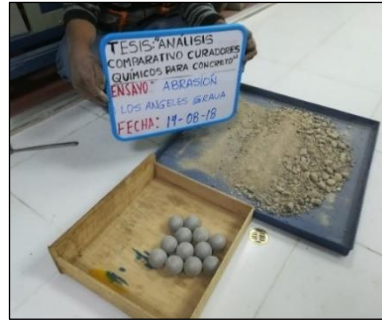
Figura 27: Muestra desgastada y esferas para abrasión.
