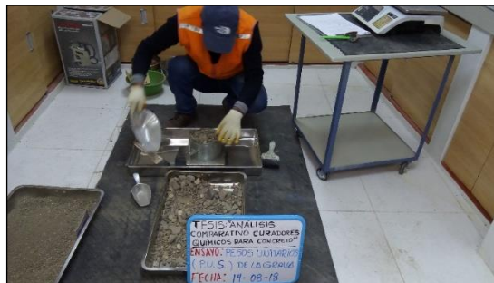
Figura 22: Ensayo para la determinación del peso unitario suelto del agregado grueso.
