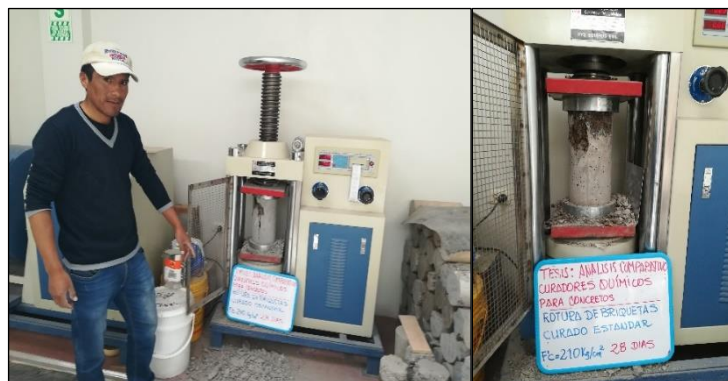
Figura 47: Probetas sometidos a esfuerzo de compresión a los 28 días.
