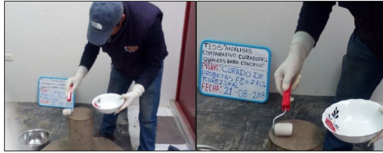
Figura 40: Curado de probetas con Kurez Seal.
