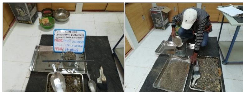
Figura 21: Ensayo peso unitario compactado del agregado grueso y fino.
