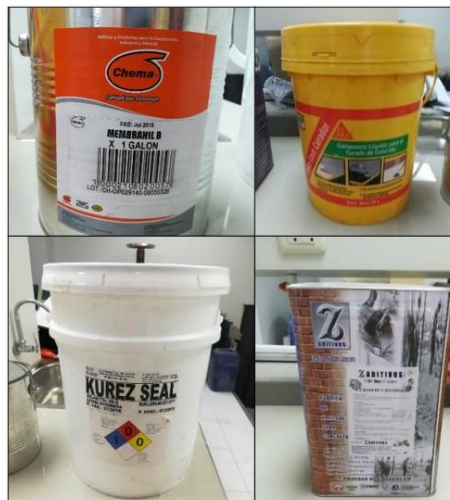
Figura 30: Curadores Membranil B, Sika Cem, Kurez Seal y Z Resinoide.
