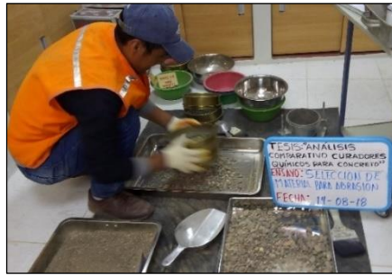
Figura 25: Cribado del agregado grueso para el ensayo de Abrasión
