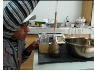
Figura 17: Materiales para determinar la condición de SSS de la arena.
