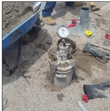
Figura 44: Olla Washington para determinación del contenido de aire.
