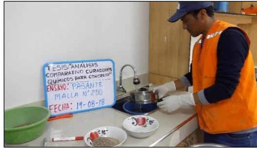
Figura 24: Lavado de muestra en el tamiz N°200 del agregado fino.
