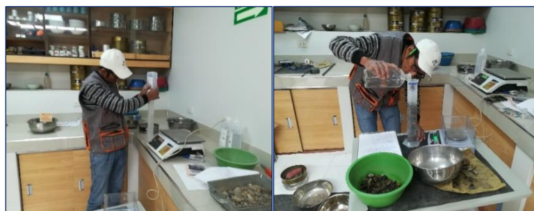
Figura 14: Determinación de volumen desplazado por la grava
