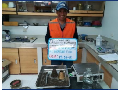
Figura 16: Gravedad específica del agregado fino.
