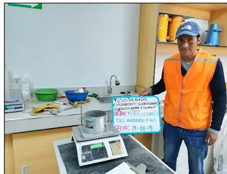
Figura 20: Determinación del peso unitario del agregado fino
