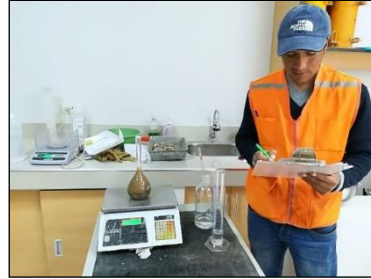
Figura 18: Toma de datos del picnómetro, muestra SSS y agua destilada
