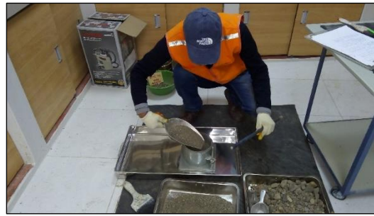
Figura 23: Determinación del peso unitario compacto del agregado fino.
