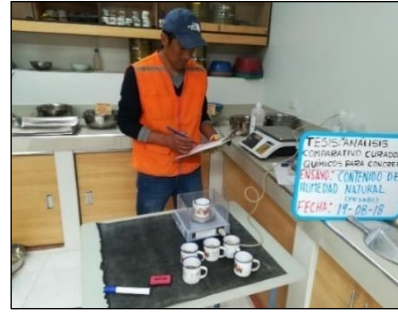
Figura 9: Lectura del peso de muestra secada al horno.
