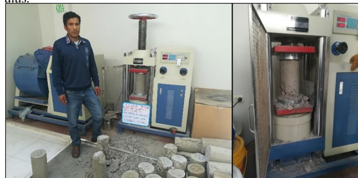
Figura 48: Probetas sometidos a esfuerzo de compresión a los 14 días.
