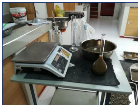
Figura 15: Materiales y equipos para determinar la gravedad específica.
