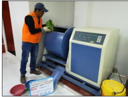
Figura 28: Colocado del agregado en la máquina de abrasión.
