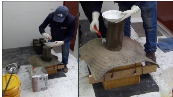
Figura 41: Curado de probetas con Z Resinoide.
