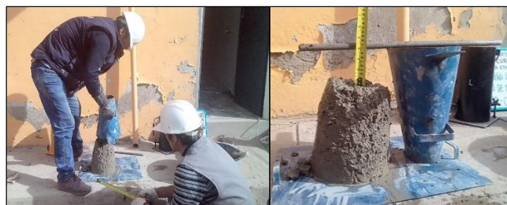
Figura 43: Ensayo de asentamiento en el cono de Abrams.
