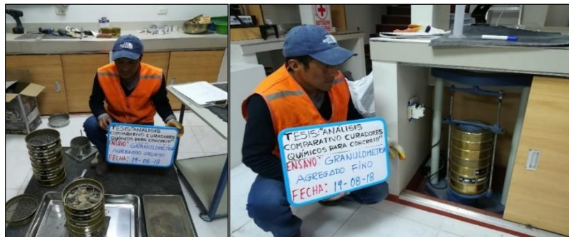
Figura 10: Análisis granulométrico por tamizado agregado grueso y fino.
