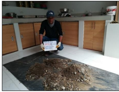
Figura 8: Cuarteo de material integral para caracterizar agregados.
