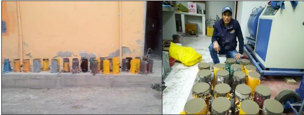
Figura 36: Moldes de 15x30cm y elaboración de probetas de concreto.
