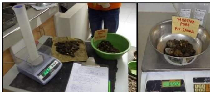
Figura 13: Secado de material saturado después de 24hr.
