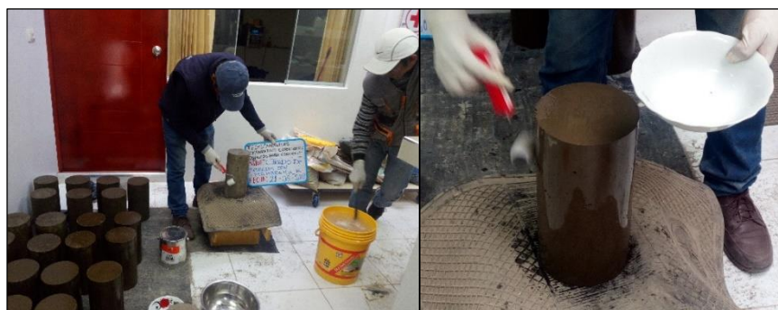
Figura 39: Curado de probetas con Membranil B.
