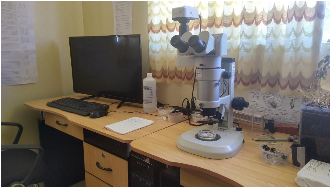
Figura 49. Estereoscopio trinocular UNITRON Z10 con cámara incorporada Infinity X Lumera y el ordenador, para la observación de los caracteres morfológicos de adultos y la genitalia de los machos de la familia Coccinellidae.
