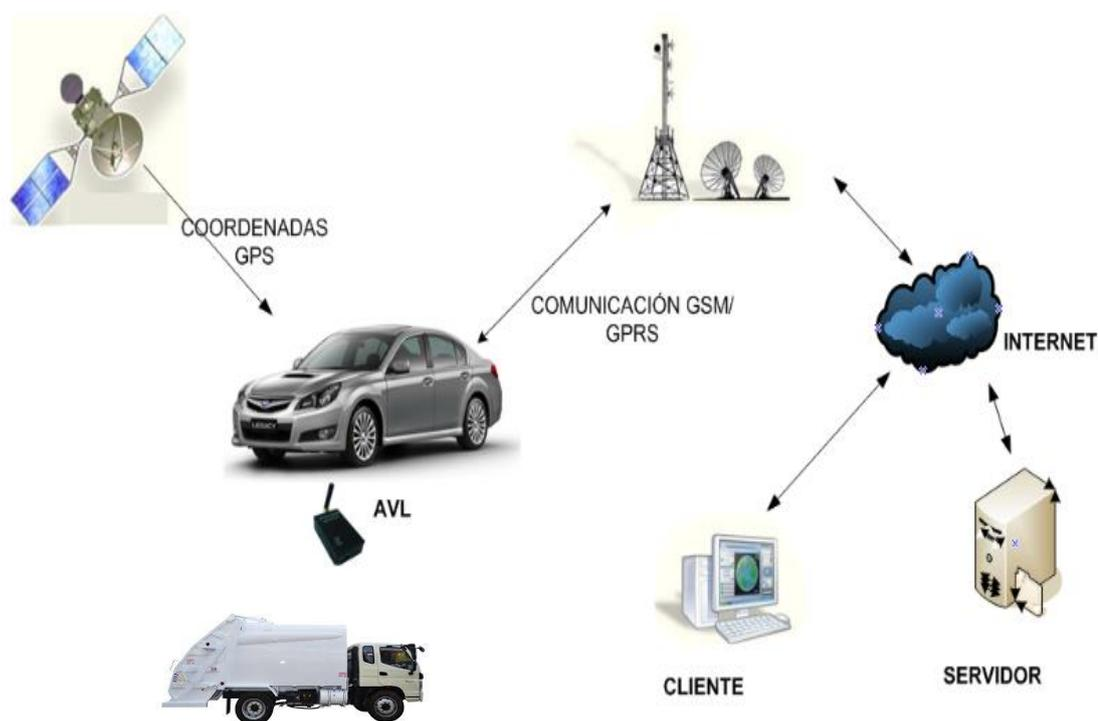
Figura 18. Esquema del sistema de ubicación de vehículos
