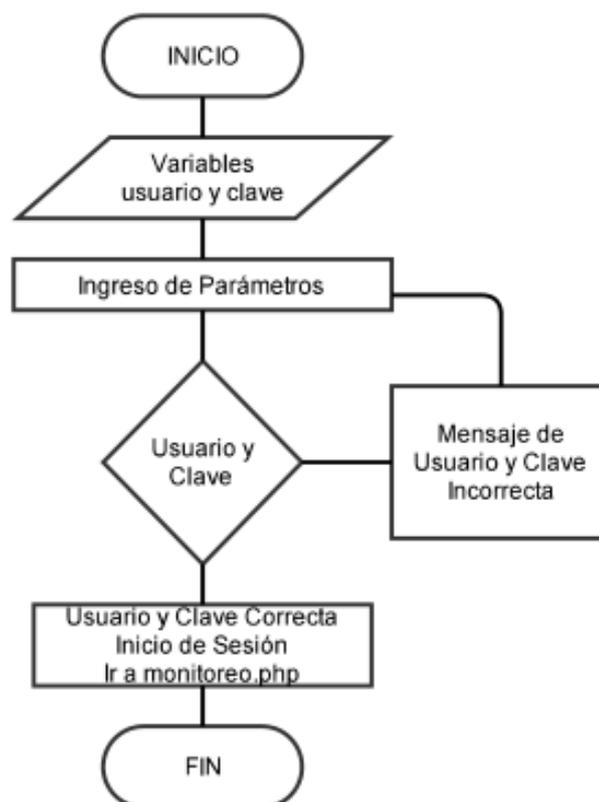
Figura 19. Diagrama de flujo de la aplicación WEB - principal
