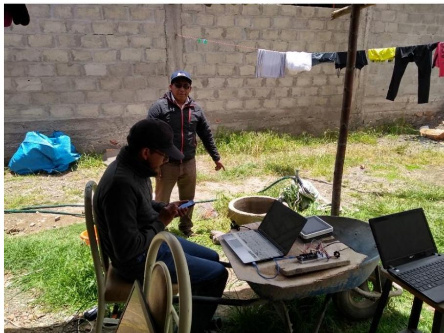
*Figura 19.* Medición de parámetros fisicoquímicos de pozo artesanal con anillos de concreto en la Urbanización Satélite, con prototipo desarrollado con Hardware y Software IDE arduino.
