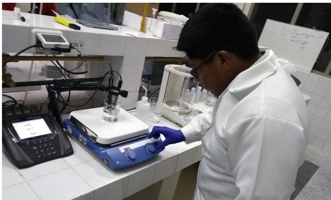
*Figura 15.* Proceso de calibración de medidor de pH y temperatura referencial Thermo Scientific Orion Versa Star Pro.
