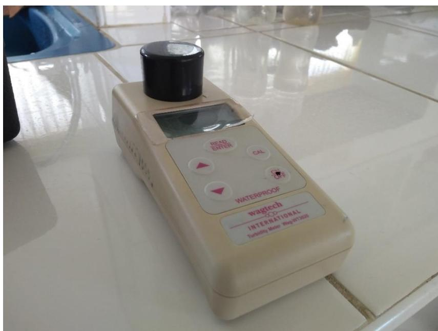
*Figura 16.* Proceso de validación de medidor de turbidez referencial turbidímetro Wagtech WAG-WT3020 y prototipo de medición.
