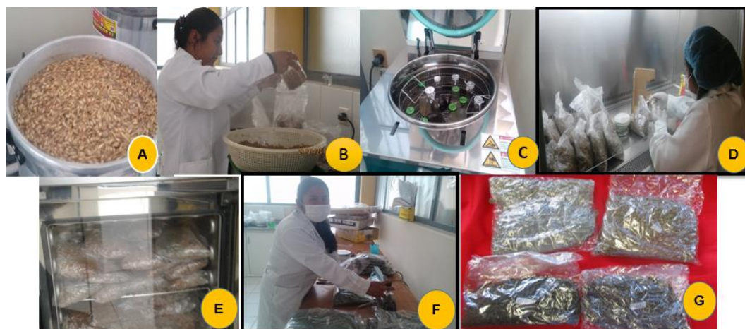
Figura 5. Producción de Trichoderma spp A. pre-cocción de sustrato de cebada. B. llenado y pesado en bolsas de polipropileno. C. autoclave a 120°C por 20 minutos. D. cámara de flujo laminar para la producción. E. incubación a 25°C. F, G. pesado y sellado de bolsas de polipropileno.
