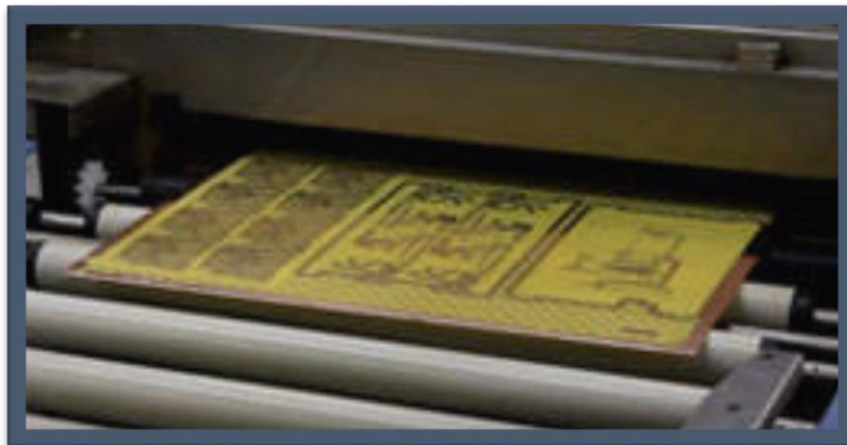
Figura 2.45: Atacado de capas externas.
