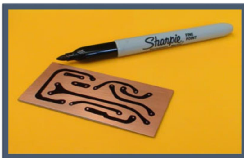
Figura 2.31: Técnica de fabricación con tinta indeleble
