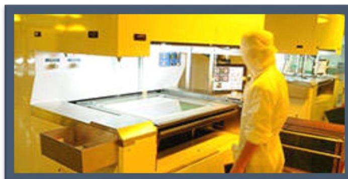
Figura 2.37: Imprimir capas internas.
