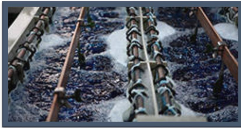
Figura 2.42: Deposición química de cobre.
