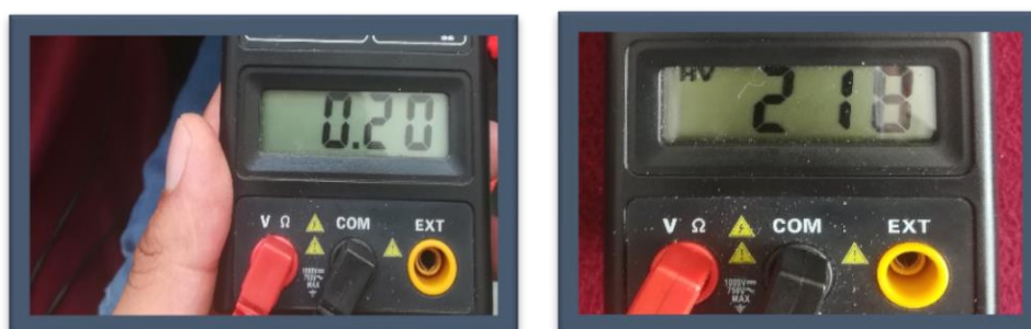
Figura 4.57: Medición de voltaje y corriente por Multímetro digital.
