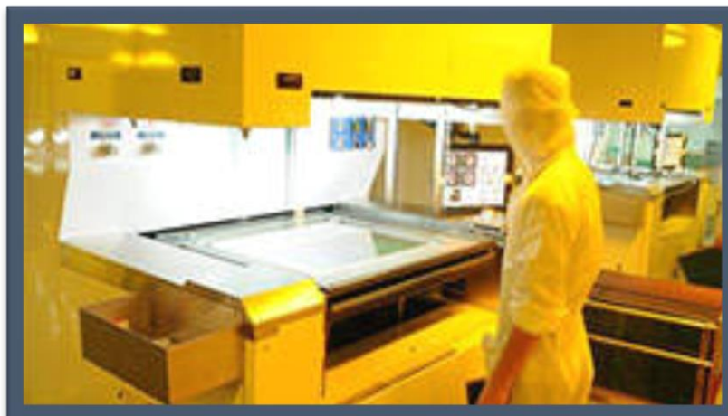
Figura 2.43: Proceso gráfico de capas exteriores.
