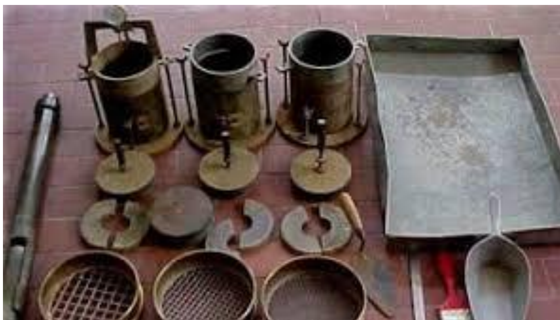
Figura N° 3. Materiales para el ensayo de CBR.
