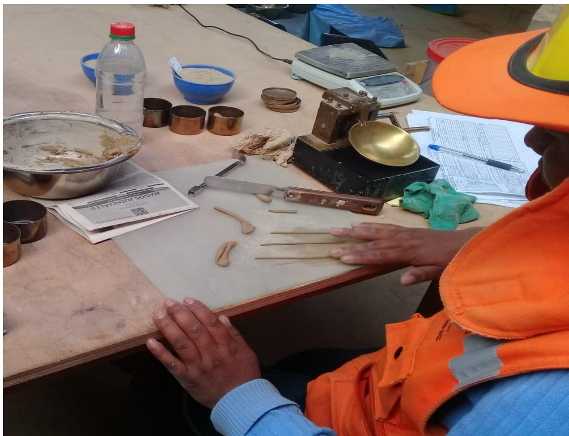
Figura N° 11. Ensayo de límites de atterbergs.
