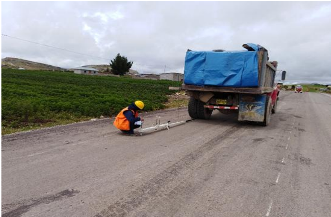
Figura N° 2. Colocado de la Viga Benkelman
