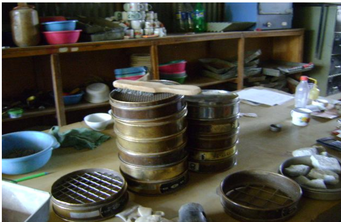
Figura N° 10. Ilustración del ensayo de granulometría.
