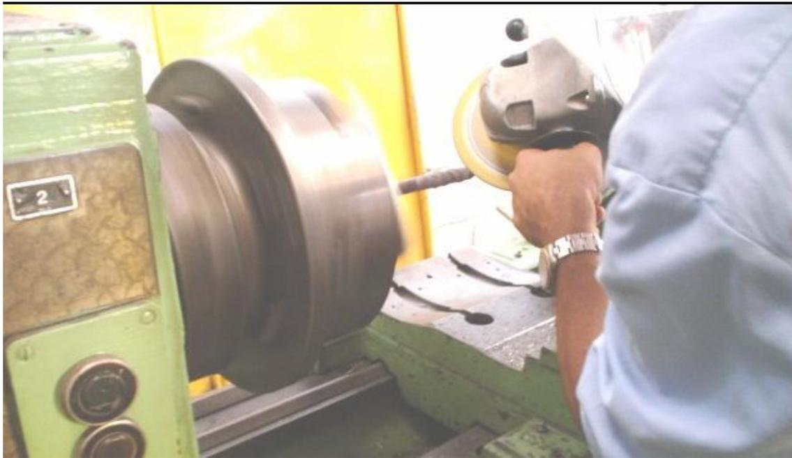
**Figura 32:** Rectificado con amoladora de disco.
