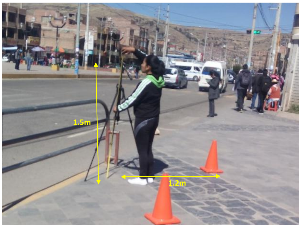
Figura 2. Ubicación y acondicionamiento del trípode que soporta el sonómetro y el multiparámetro.
