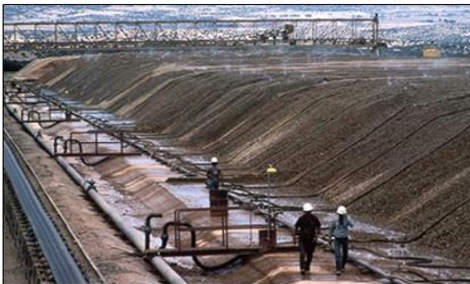
**Figura N° 7:** Lixiviación en pilas
