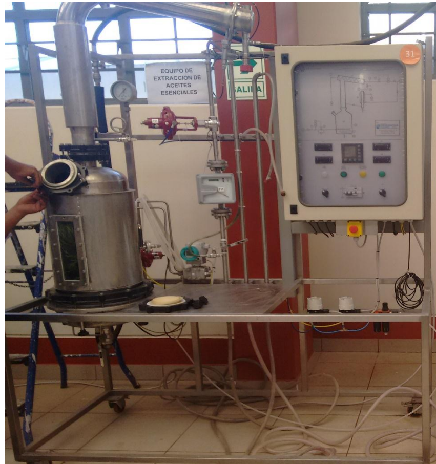
Figura 2. El extractor de los aceites esenciales consiste en un equipo de destilación discontinua marca Elettronica Veneta, el cual está conformado por un generador de vapor SCT04/EV, una cámara de extracción en el cual se colocará el material vegetal, un condensador el cual utiliza agua fría de la red pública, un vaso de florentino recolector y una pera de decantación para separar el aceite del agua.
