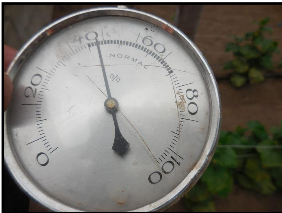
**Figura 30.** Higrómetro utilizado en el invernadero
