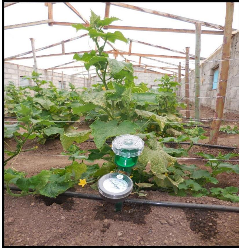
**Figura 19.** El tensiómetro en la parcela experimental
