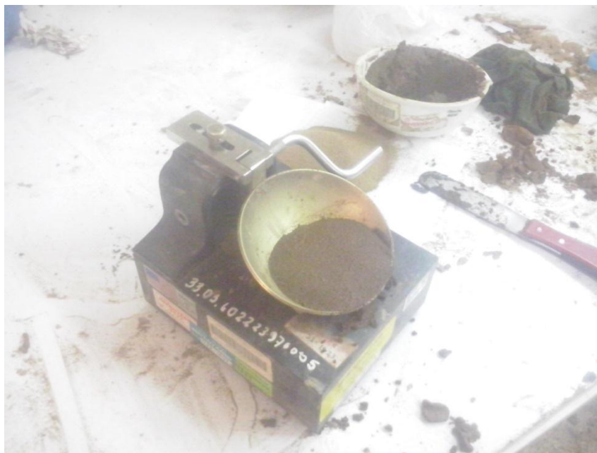
Figura 7: Se realiza el ensayo de límite líquido.
