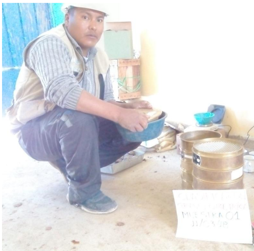
Figura 6: Se realiza el tamizado para determinar su clasificación.
