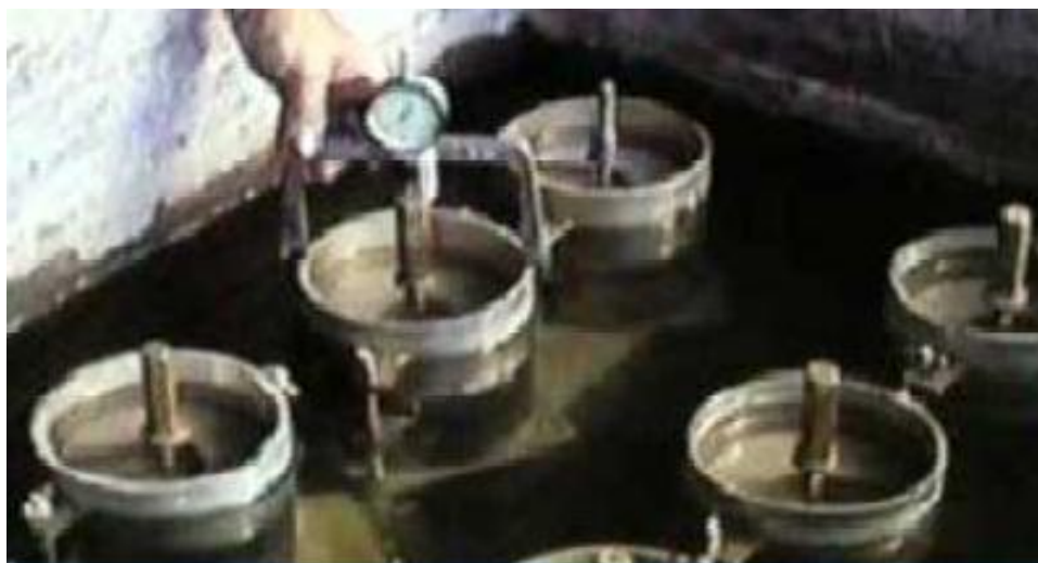
Figura 11: Verificación de la expansión.
