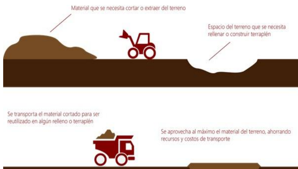
Figura 2: Corte y relleno de terraplén.
