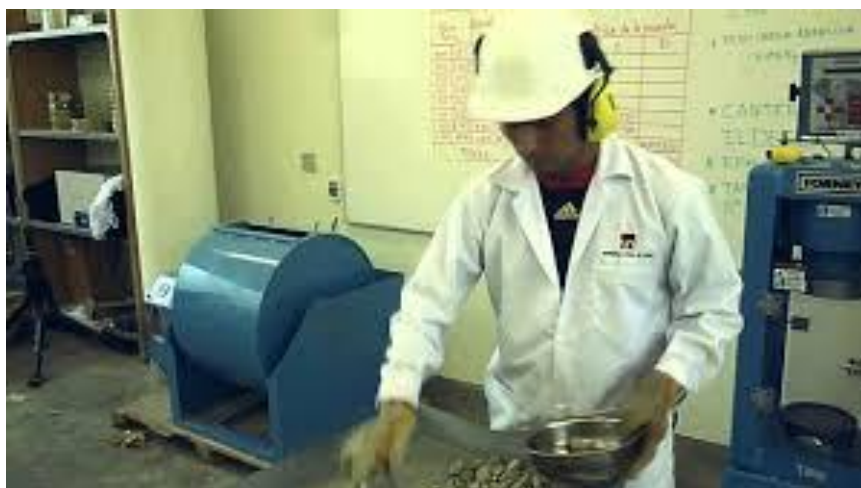
Figura 12: Ensayo abrasión de los ángeles.
