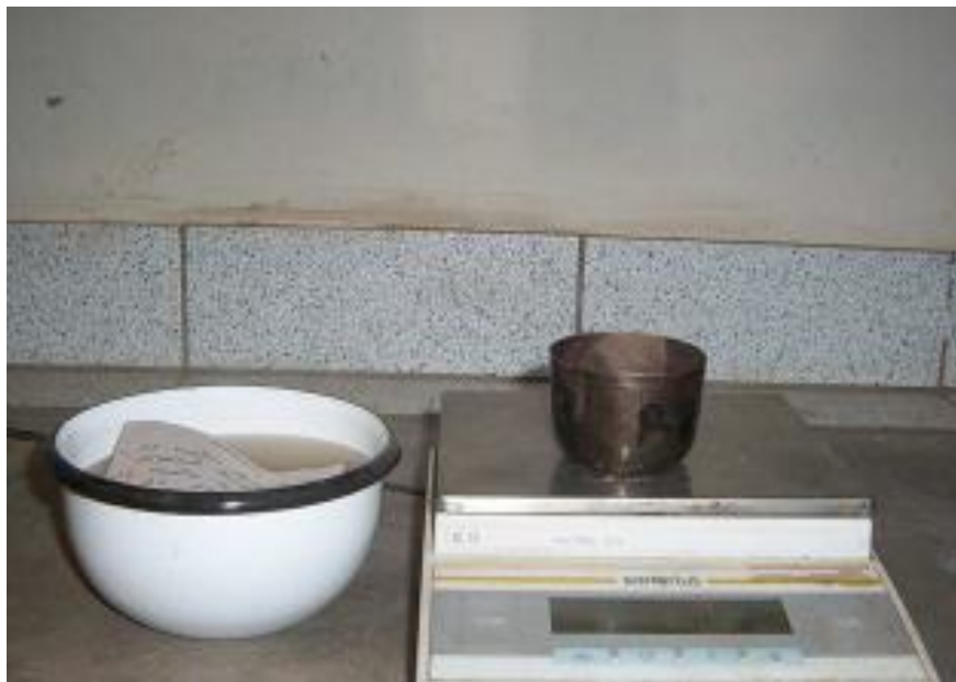
Figura 9: Se pesa el material secado, para determinar la humedad natural.
