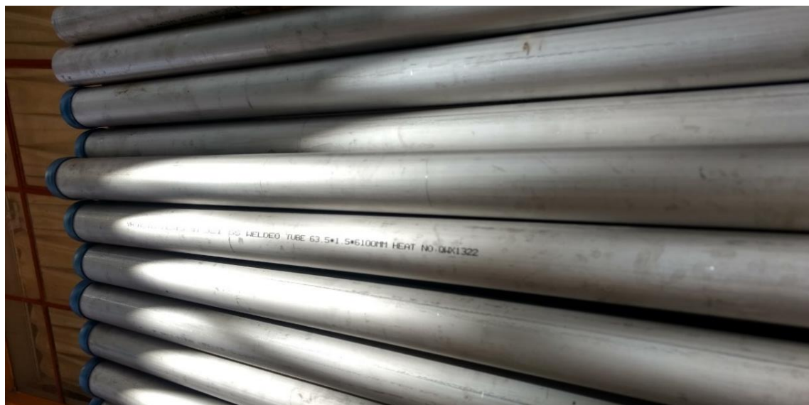
Fotos de corte de la plancha inox. Abajo: Tubos intercambiadores de calor
