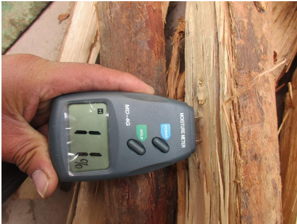
Foto de medición de humedad de leña 1
