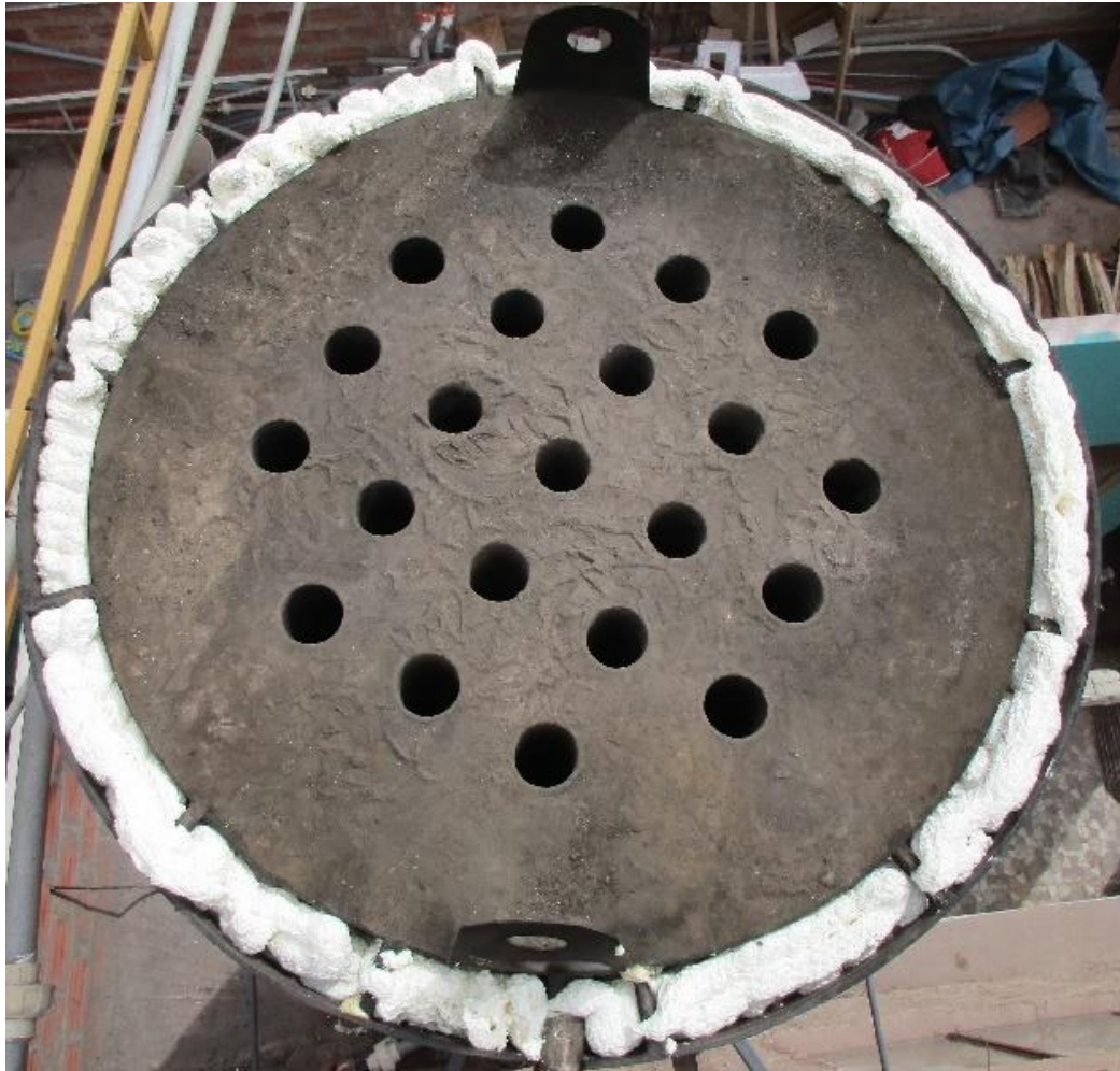
Figura N.º 3.14: Vista superior del caldero. Se muestra el aislante térmico y las orejas de izaje
