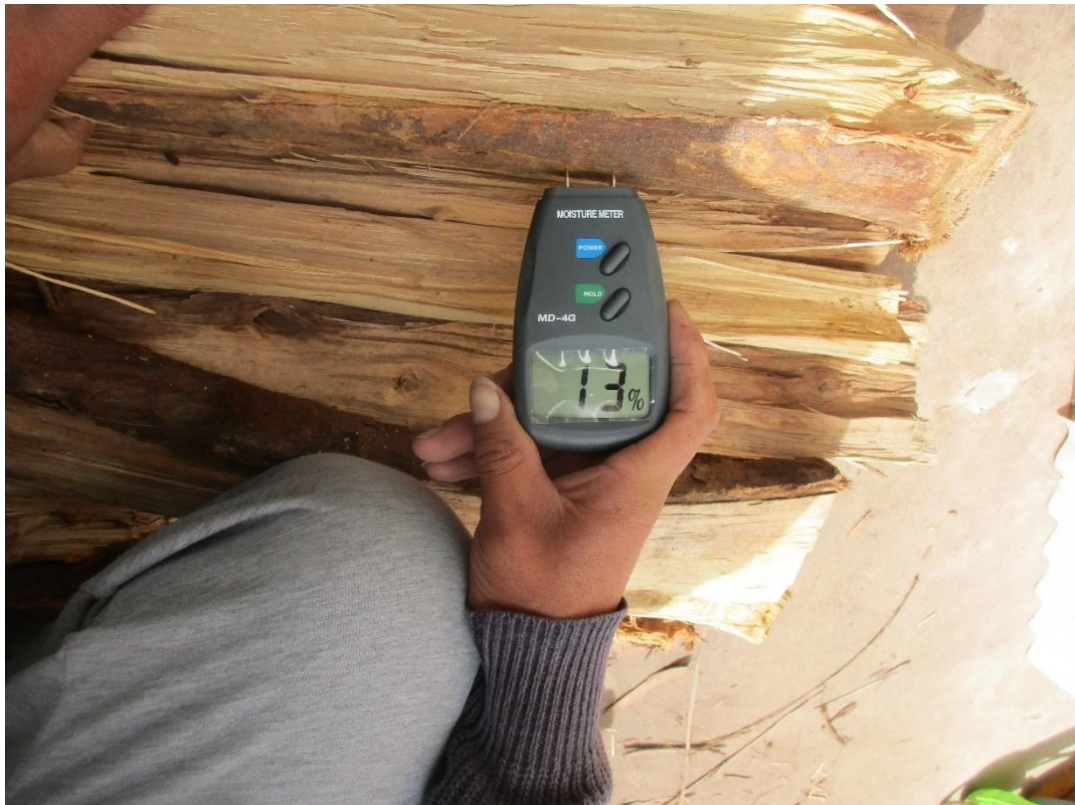
Foto de medición de humedad de leña 3
