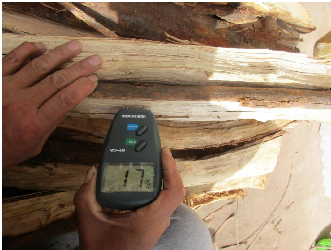
Foto de medición de humedad de leña 4
