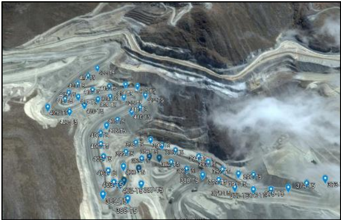
Figura 5: Ubicación de delineadores en tramo 5.
