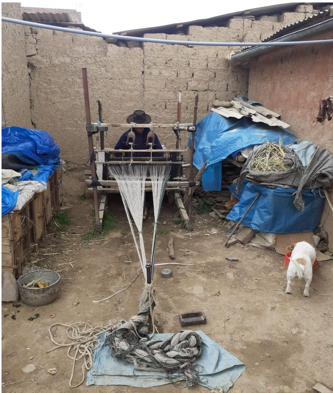
**Figura 27:** Proceso de urdido para la elaboración de frazadas.
