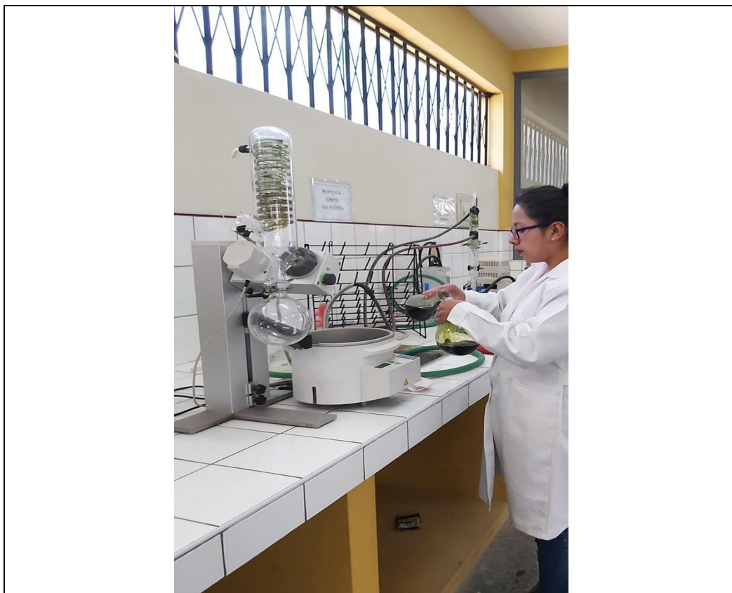
Figura 22. Colocación del extracto de lípidos no polares al rotavapor (BUCHI / R-3HB) para la recuperación del solvente.
