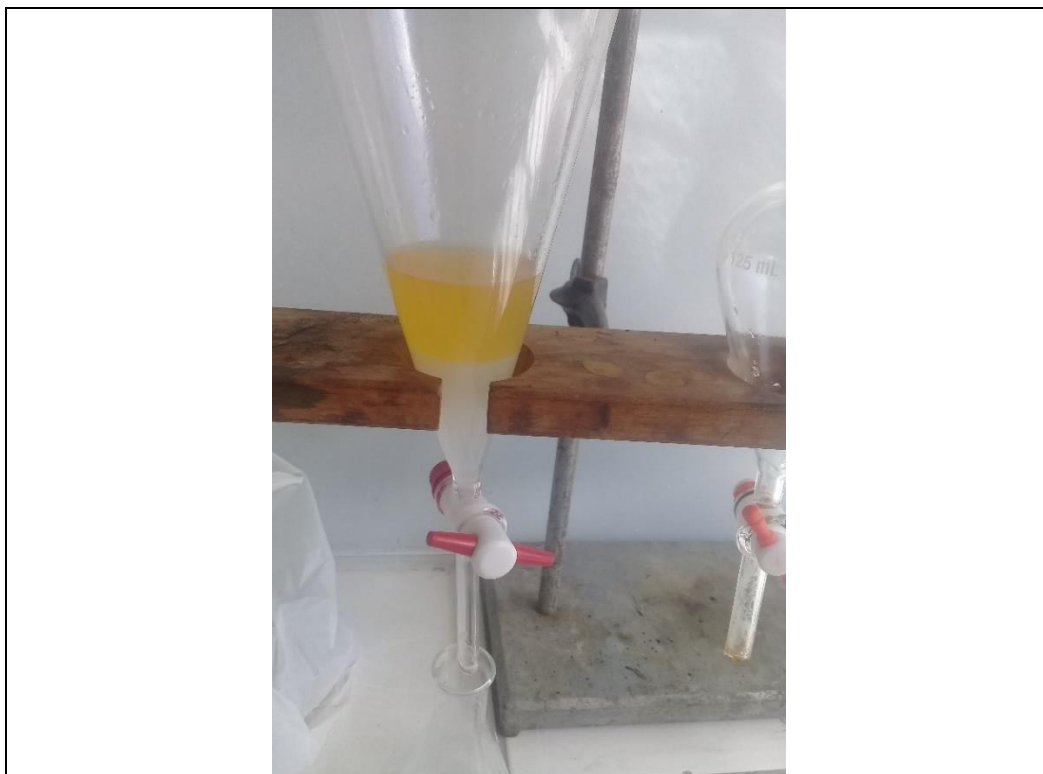
Figura 30. Lavado del biodiesel de Lentejas de agua ( Lemna gibba ).
