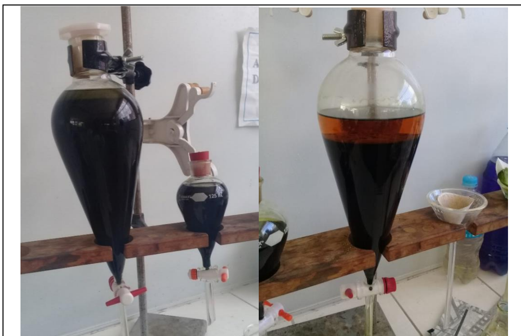
Figura 21. Separación de lípidos no polares y lípidos polares gracias a la adecuación del método Folch.
