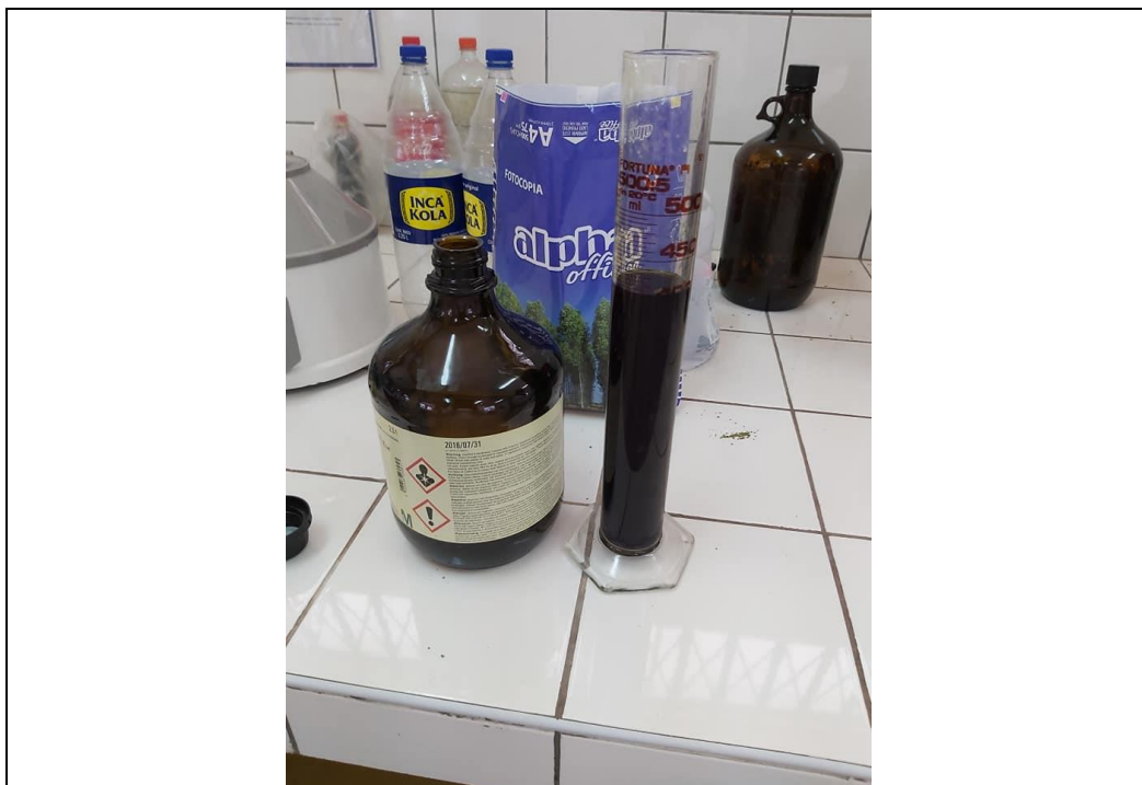
Figura 20. Medición del extracto después de la incubación por 24 h de Lentejas de agua ( Lemna gibba ) en metanol: triclorometano (1:2) para añadir la solución salina.
