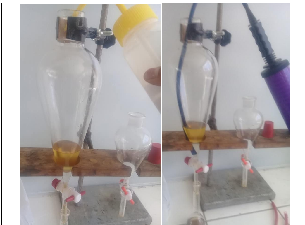
Figura 29. Lavado del biodiesel crudo de Lentejas de agua ( Lemna gibba ).
