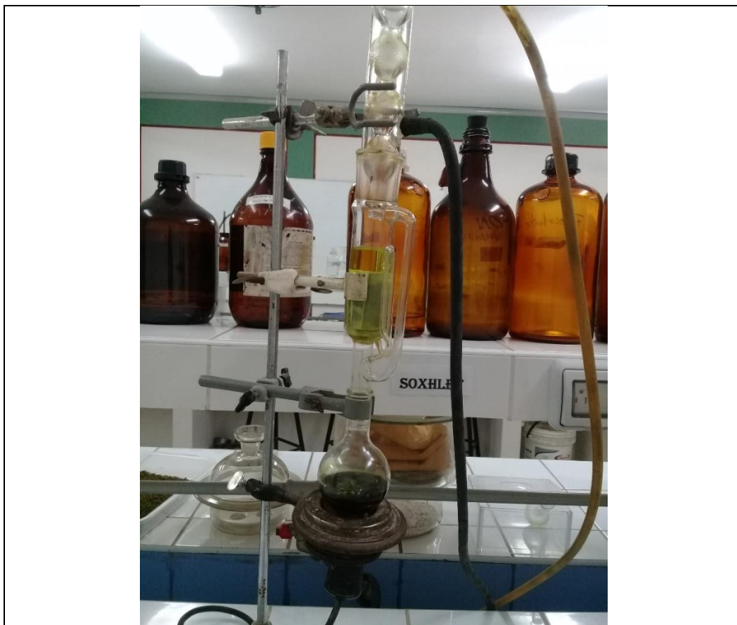
Figura 17. Extracción de lípidos por el método Soxhlet.
