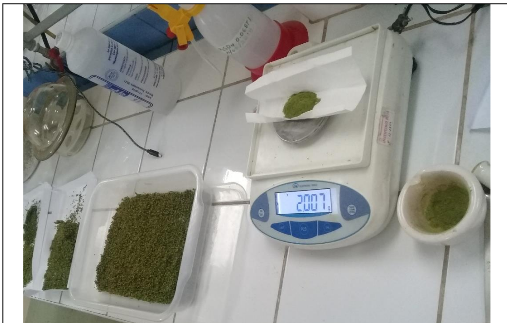
Figura 16. Pesado de muestra para la obtención de Lípidos por el método Soxhlet.
