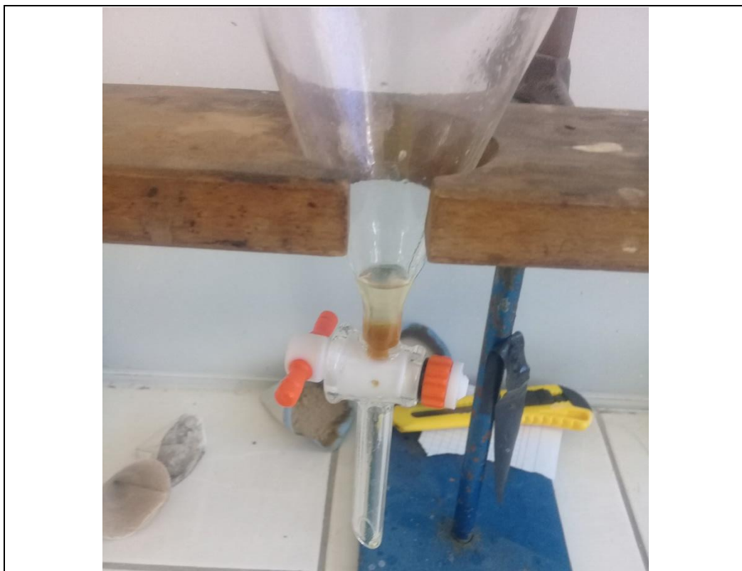
Figura 28. Separación del biodiesel y 1,2,3-propanotriol (glicerina).
