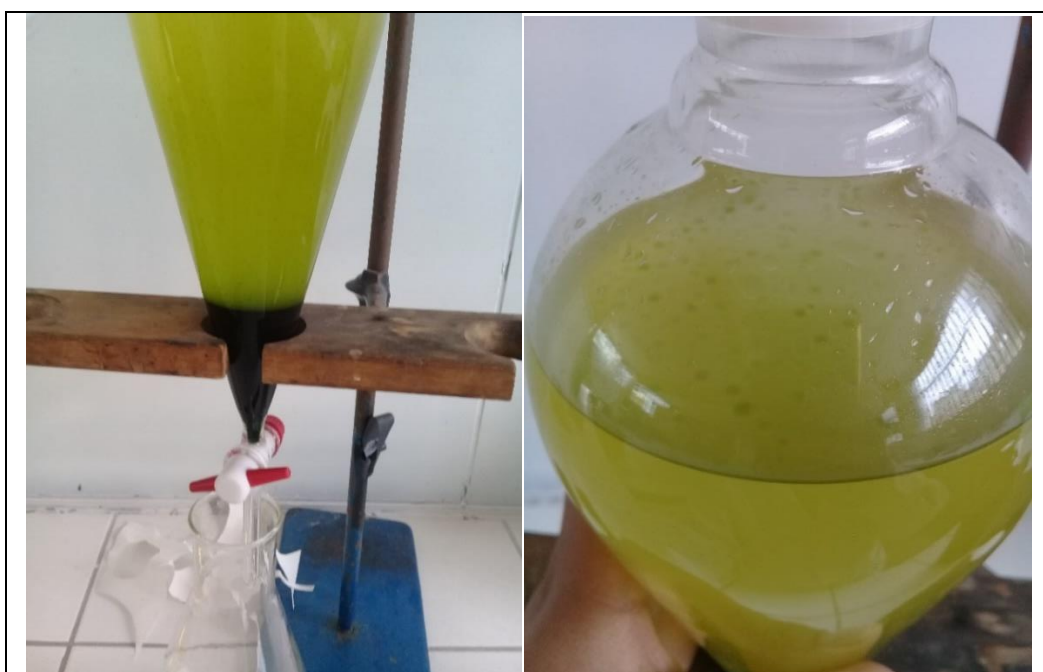
Figura 19. Separación de lípidos polares y lípidos no polares por la adecuación al método Bligh & Dyer.
