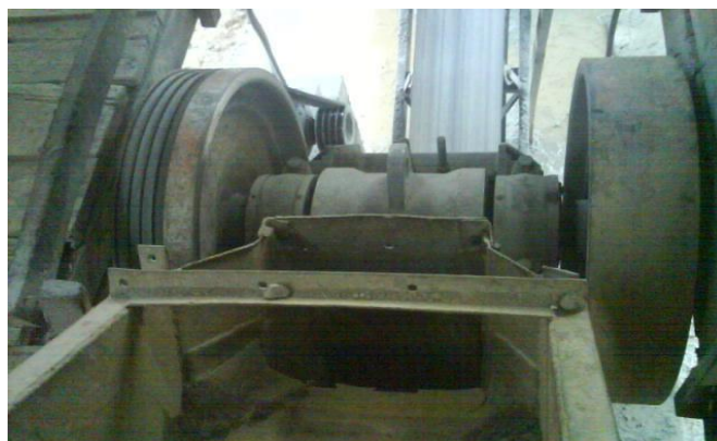
Figura N° 21: Se observa la chancadora de quijadas (9" x 12") del circuito de Chancado de Planta San Carlos.
