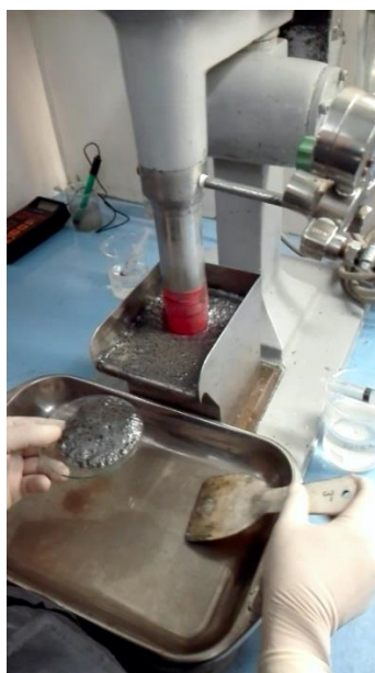
Figura N° 34: Celda de flotación Denver D-12
