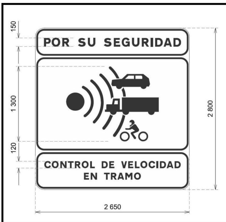
**Figura N° 23: Señal I-3B - Señal de control de velocidad en tramo**
