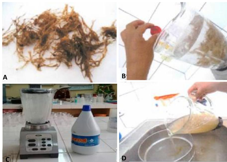
**Figura 7.** Técnica de la licuadora con centrifugación para muestras de raíces (A: Raíces infestadas con *Meloidogyne*, B: Adición de Hipoclorito de sodio, C: Licuado a máxima velocidad por un minuto, D: pasado de restos vegetales de raíz en el tamiz de 400 Mesh).
