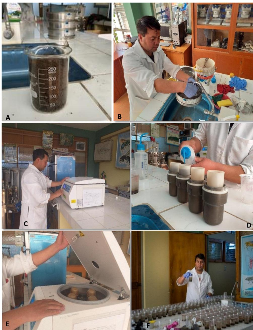
**Figura 6.** Fluctuación centrifuga para extracción de nematodos (A: 250cm<sup>3</sup> de suelo, B: Lavado de muestra de suelo en tamiz de 400 Mesh, C: Centrifugado con cal durante 2 minutos, D: nivelado de muestras en tubo con solución sacarosa, E: retiro de tubos de centrifugado con solución sacarosa, F: muestras en vasos de plásticos).
