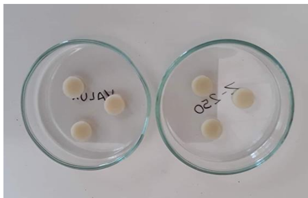
Anexo 11. Figura 7. Muestra de Resinas sumergidas en agua destilada (grupo control)
