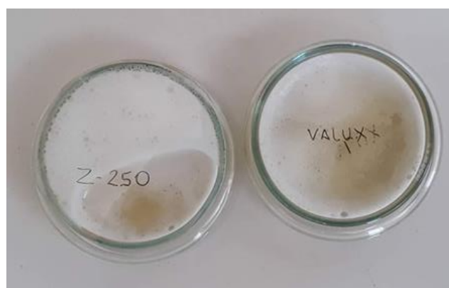
Anexo 12. Figura 8. Muestra de Resinas sumergida en la bebida carbonatada alcoholica (grupo experimental)
