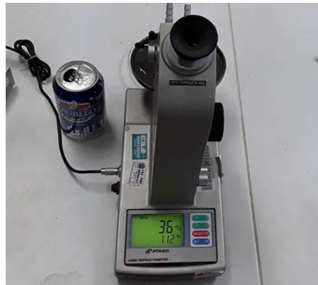
Anexo 5: Figura 1. Alcoholímetro
