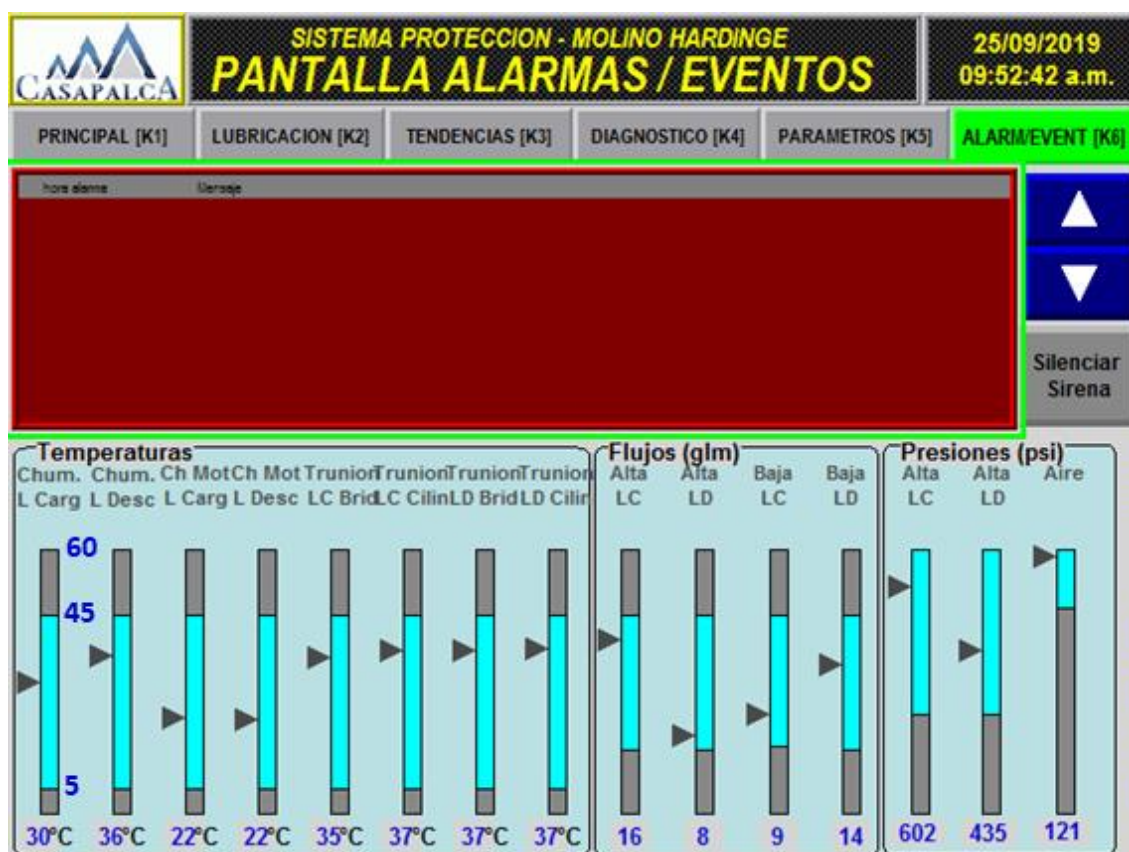
Figura 42: Pantalla de alarma y eventos del sistema de protección.
