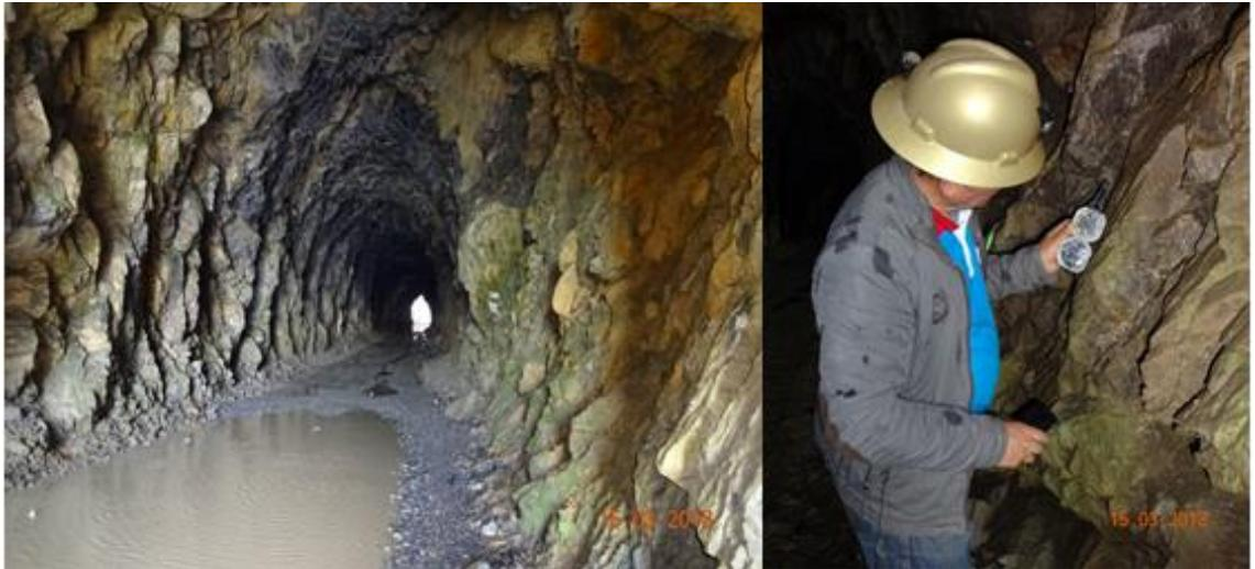
*Figura 27.* En la imagen de la izquierda se muestra el Túnel II en toda su longitud, y en la imagen de la derecha se está realizando la medición de mapeo geomecánico de las discontinuidades.
