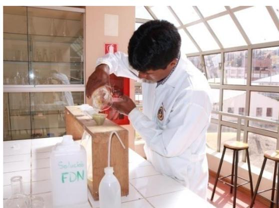
**FIGURA 39.** Determinación de FDN (filtrado de muestra).
