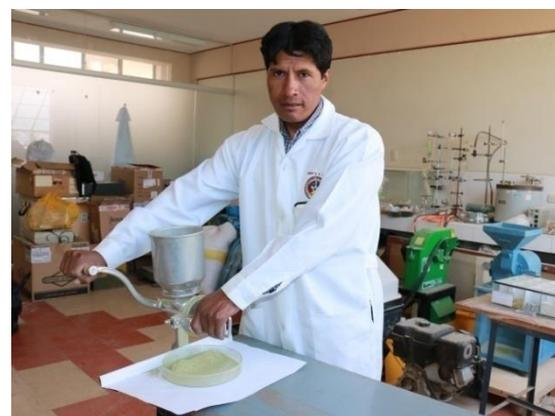
**FIGURA 36.** Molido de los forrajes para su análisis químico en Laboratorio.
