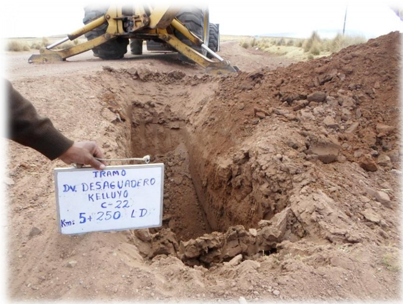
FOTO N°03: En la calicata N°22 se observa un suelo limoso, de color pardo claro con una plasticidad media, al lado derecho de la carretera de la prog. 5+250.
