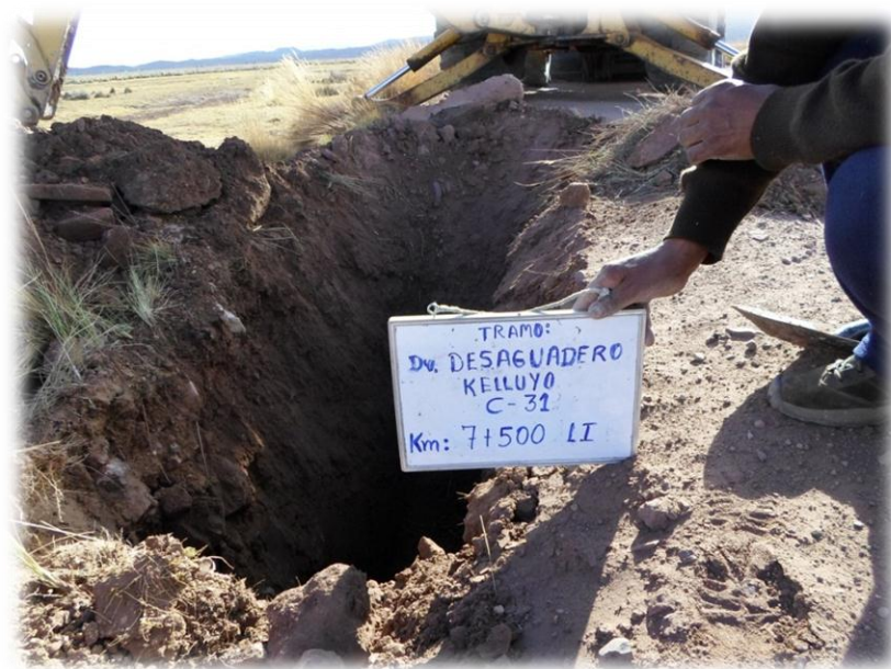
FOTO N°04: En la calicata N°31 se observa un suelo limoso de color pardo claro con una plasticidad media a alta al lado izquierdo de la carretera de la prog. 7+500.
