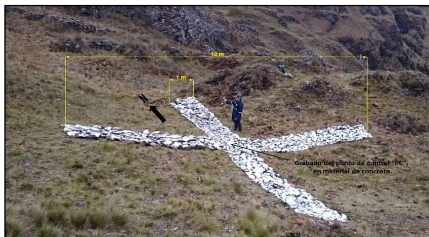
Figura N° 18. Puntos de control topográfico “PC-#” y grabado en material de concreto.
