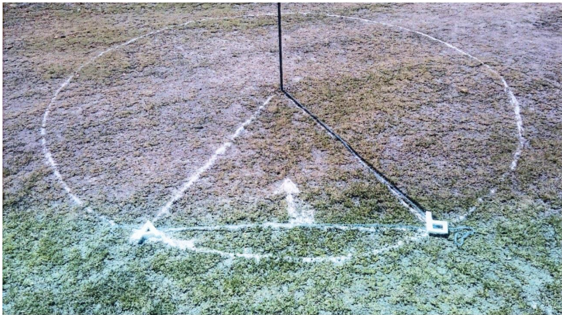
Figura 4.3. Determinación experimental del norte geográfico.
