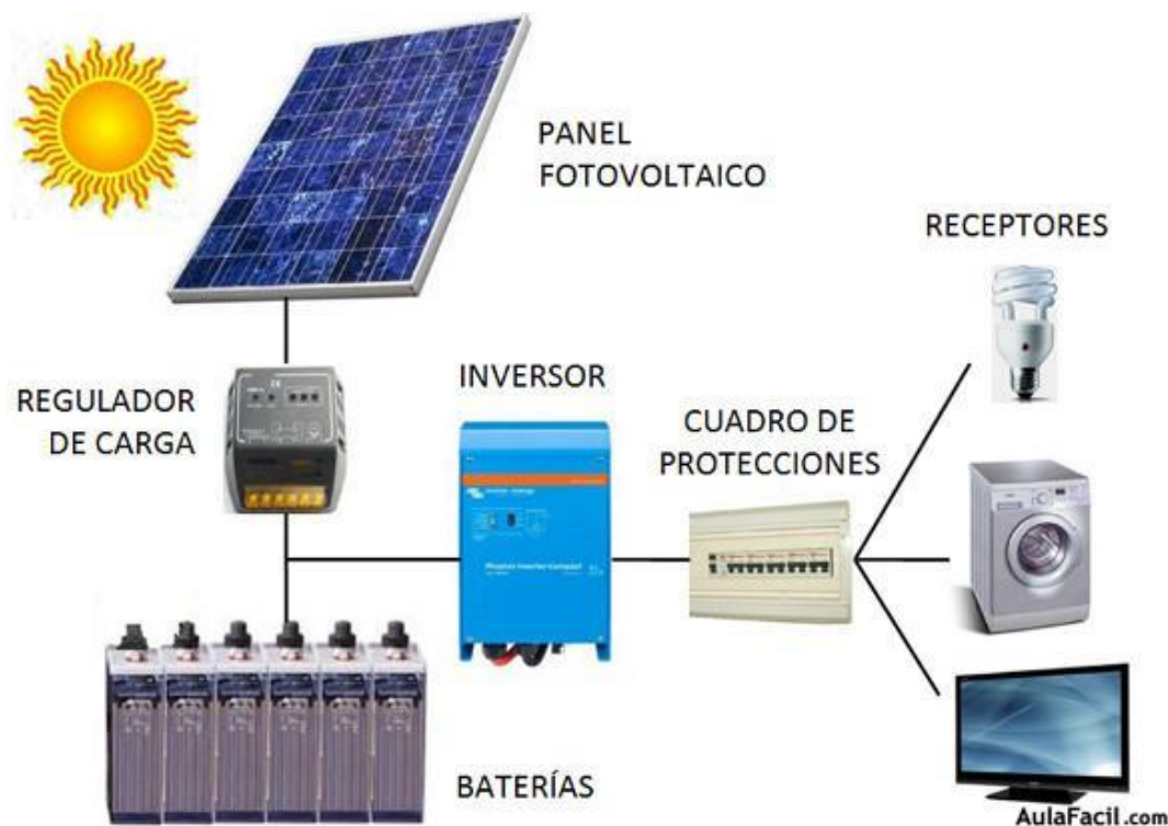
Figura 2.19. Instalación Fotovoltaica Aislada de la Red Eléctrica
