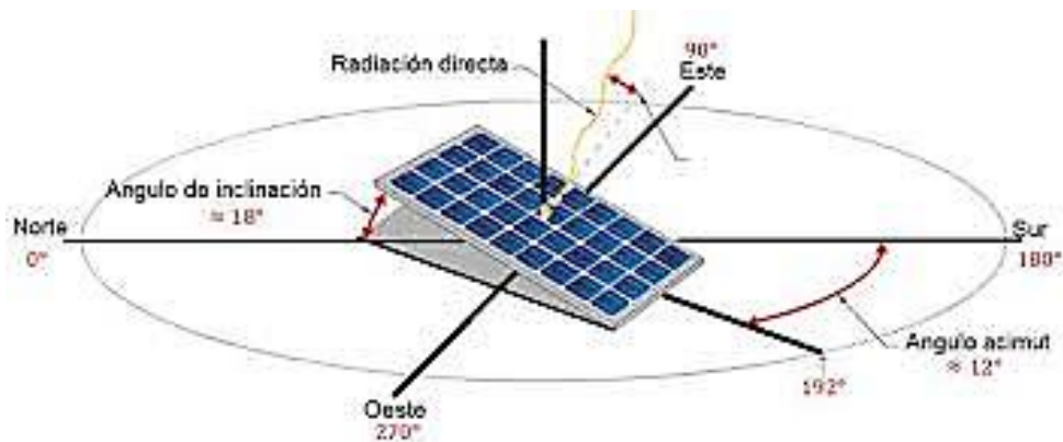
Figura 2.25. Ángulos de Inclinación ( \beta ) y Acimut ( \alpha )
