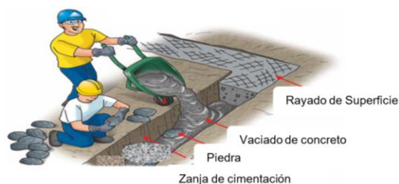
Figura 106. Colocación de concreto en cimiento corrido Fuente: Manual del maestro constructor Aceros Arequipa
