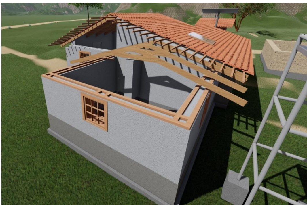
Figura 78. Viga collar en vivienda para 05 personas
