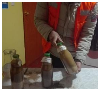
Figura 95. Agitación de botella con tierra y agua
