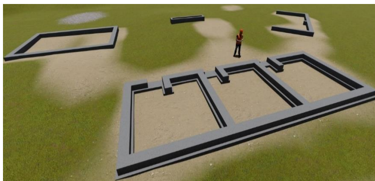
Figura 109. Cimiento corrido y sobrecimiento de vivienda para tres personas
