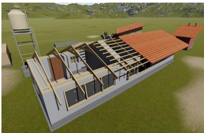
Figura 91. Viga collar en propuesta de vivienda rural para 03 personas
