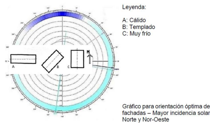
Figura 123. Gráfico de orientación óptima de viviendas mayor incidencia solar Fuente: Diseño de vivienda rural bioclimática-Sandra Barrantes Pucci
