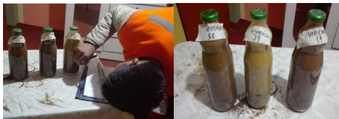
Figura 96. Marcación de altura de arena Fuente: Elaborado por el equipo de trabajo
