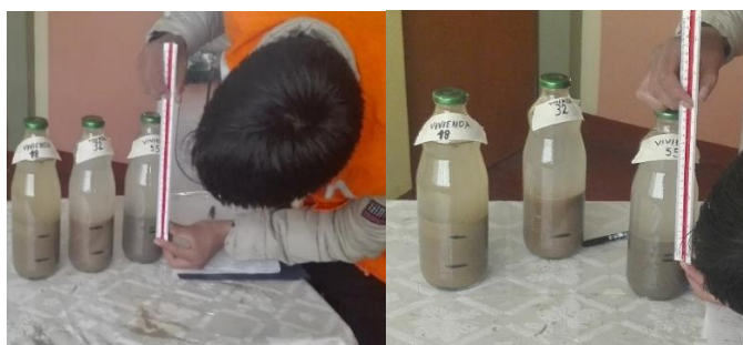
Figura 97. Medición de altura de limo y arcilla 24 horas después Fuente: Elaborado por el equipo de trabajo
