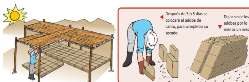
Figura 6. Secado y apilado de adobes
