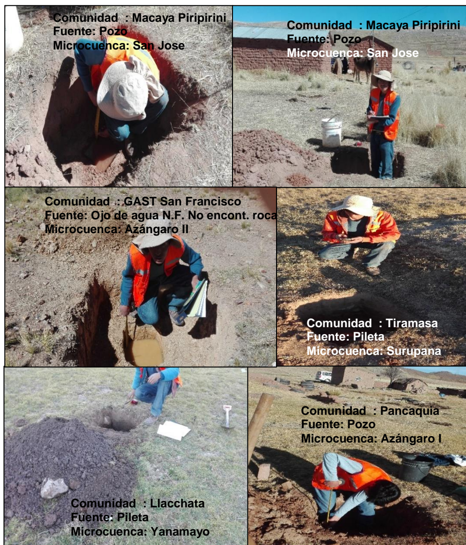
Figura 60. Realización de prueba de infiltración Fuente: Elaborado por el equipo de trabajo
