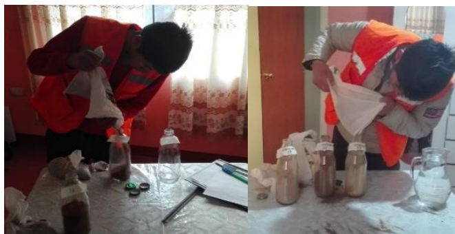
Figura 94. Llenado de tierra y agua en botella de boca ancha
