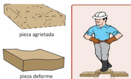
Figura 7. Prueba de resistencia del adobe
