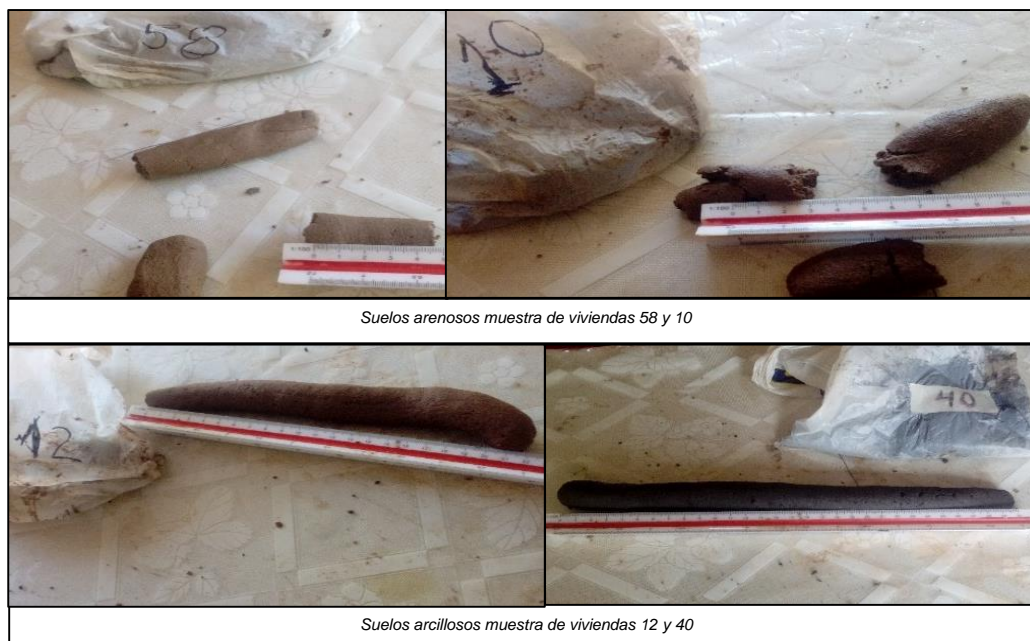
Figura 98. Prueba de rollito para la verificación de la calidad del material
