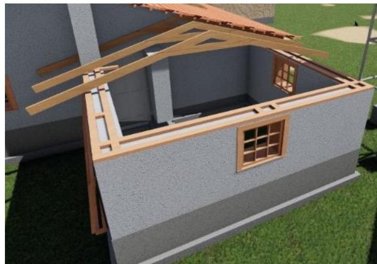
Figura 120. Detalle de Tijerales y correas de vivienda rural cinco personas Fuente: Elaboración propia
