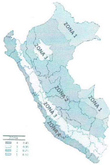
Figura 3.1: Zonificación sísmica de Perú, según el Reglamento E.030 de Diseño Sismo Resistente
