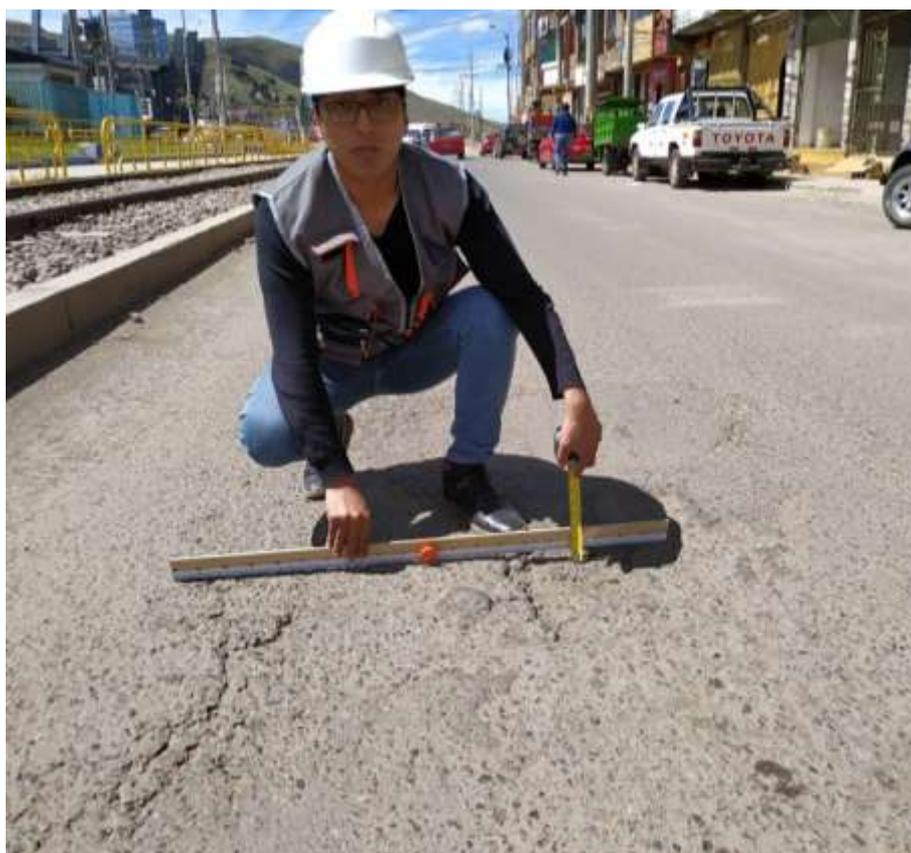
Fig. H.2 Falla Grieta Longitudinal en Pavimento Flexible.
