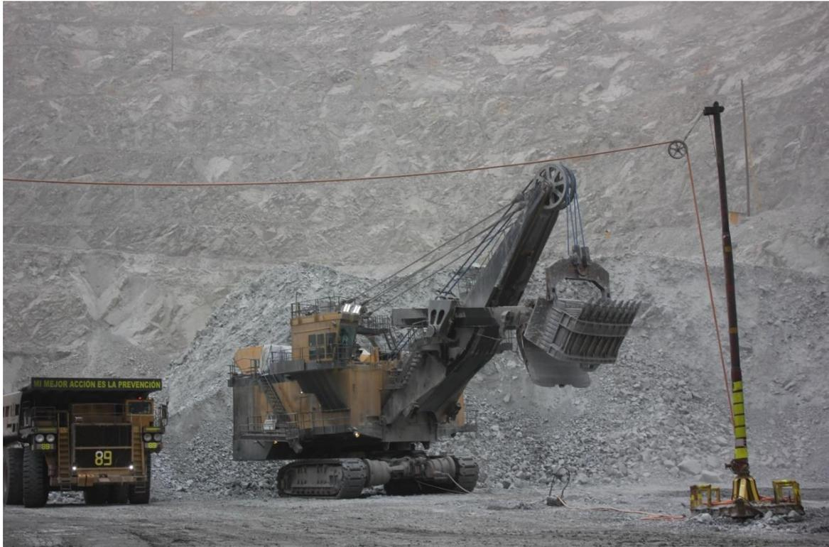
Fotos 3. Desplazamiento de la pala eléctrica
