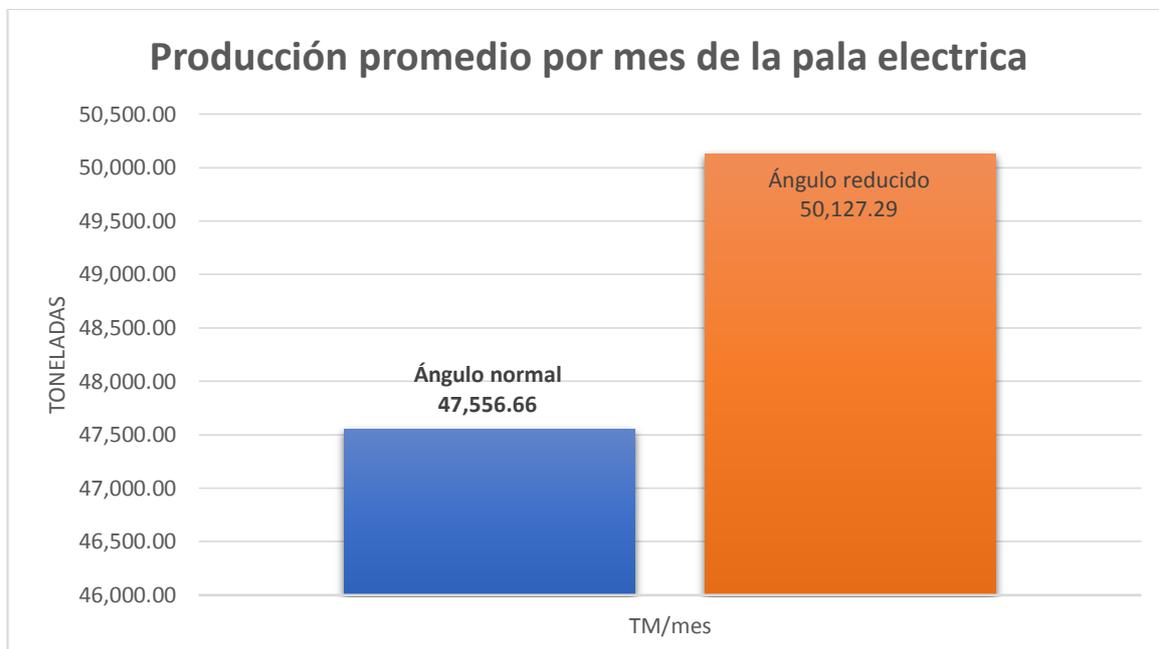
Figura 41. Comparación de producción de toneladas por mes de la pala eléctrica
