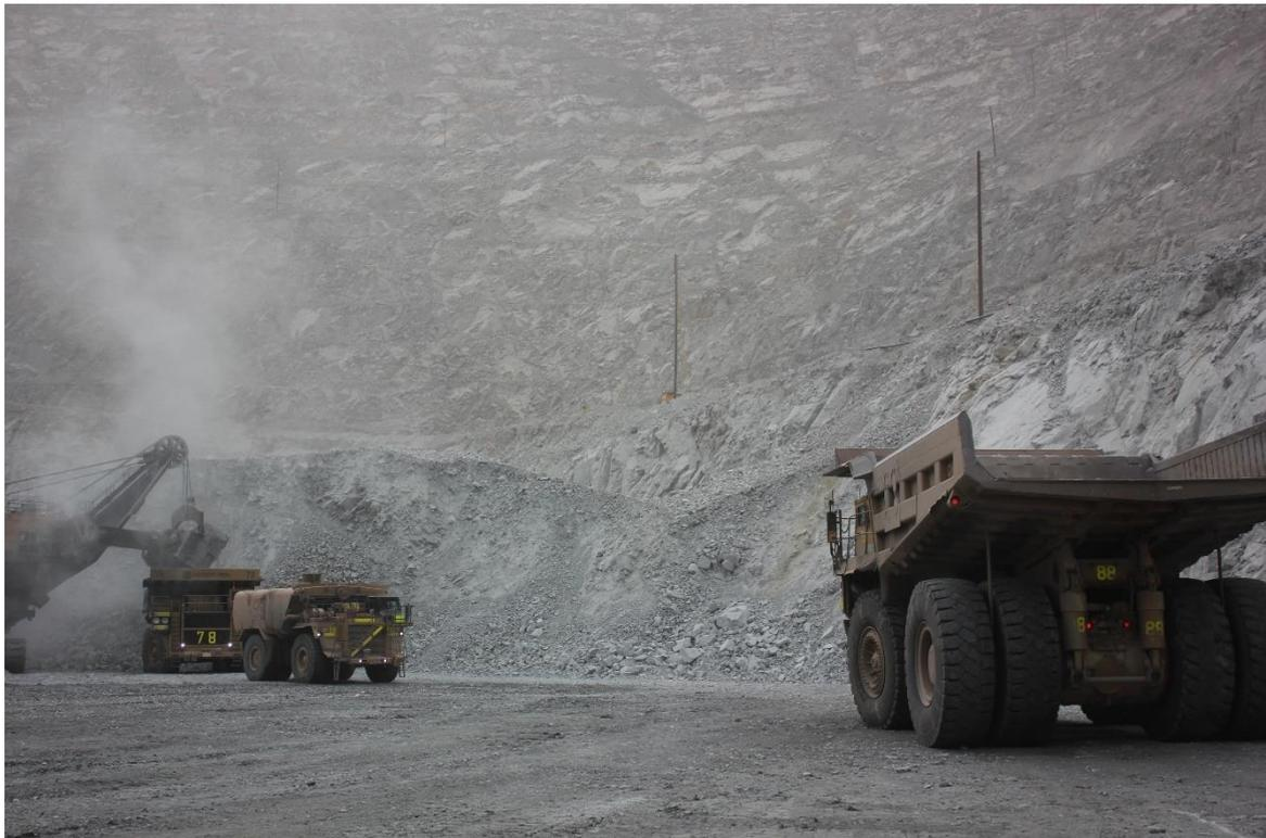
Fotos 1. Pala eléctrica P01cargando al camión minero
