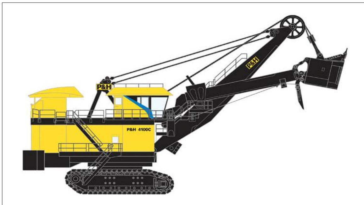
Figura 1. Pala eléctrica de cable
