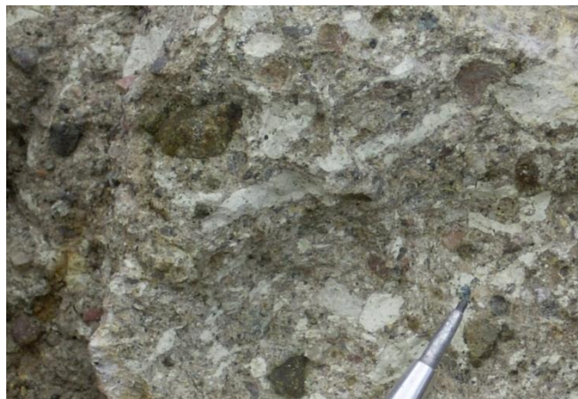
Figura N° 38: Muestra con Alteración Hidrotermal, sericitización fuerte de los cristales de hornblendas.
