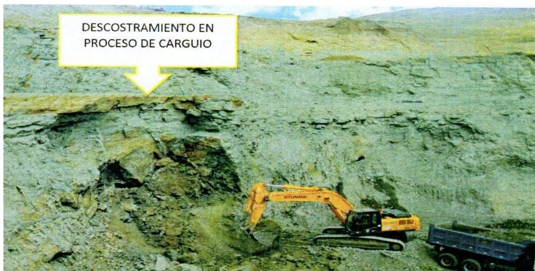
**Figura 74: Descostramiento en carguío en banco de producción 4330S - 4325S**
