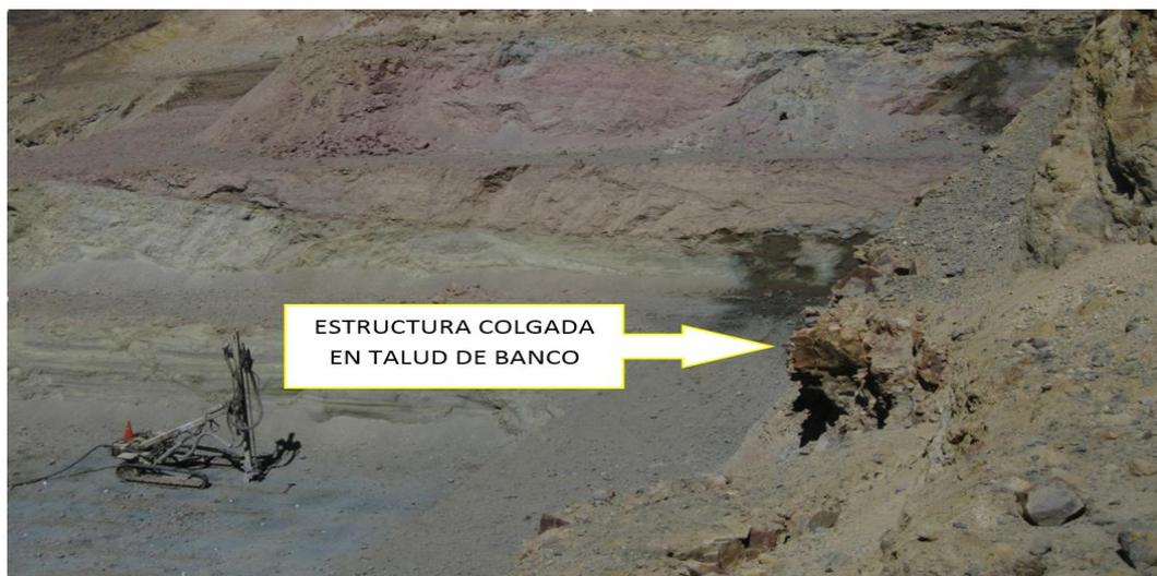
**Figura 76: Estructura de macizo rocoso colgado en banco de producción 4330S – 4325S**
