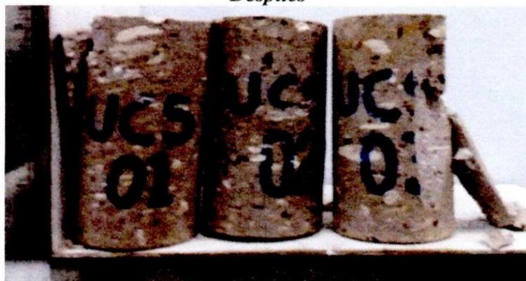
**Figura 70: Resultado de compresión simple antes y después de aplicación de esfuerzos.**
