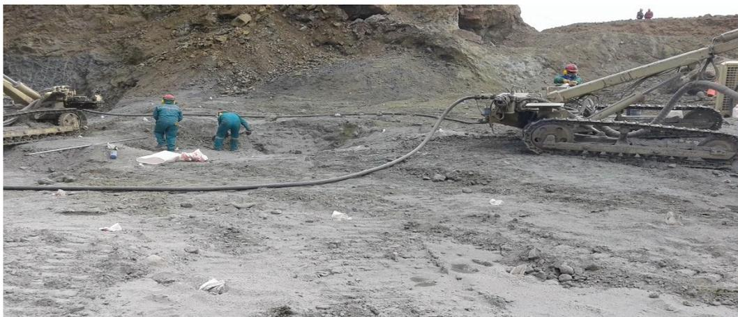
**Figura 91: Preparación de malla de perforación COEMPSA - CIEMSA Tacaza**
