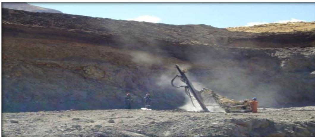
**Figura 72: Perforación de pre corte en tajo central.**
