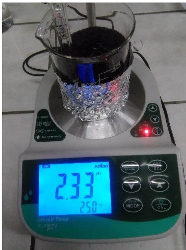
Figura 45: Medición de pH del colorante de maíz morado
