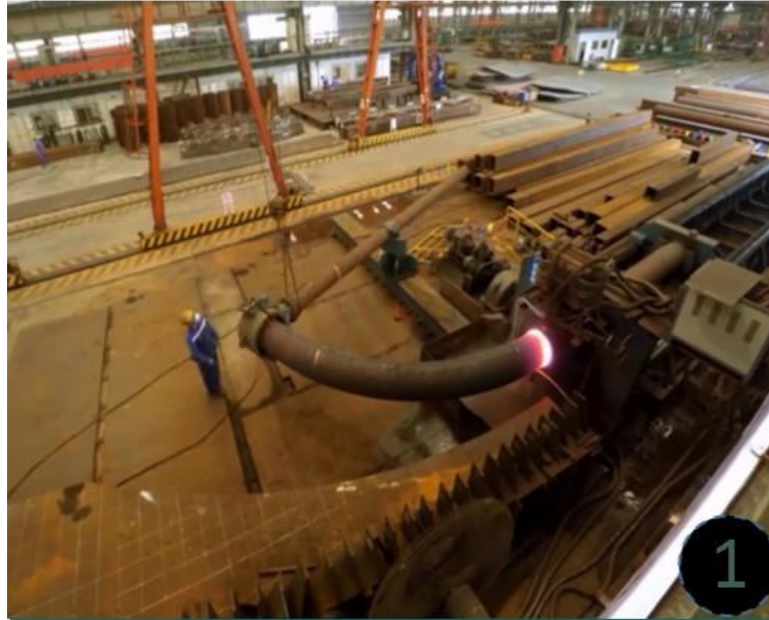
● PROCESO DE DOBLADO DEL PERFIL DE ACERO
