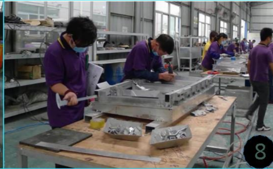
● MONTAJE DE SUB-ESTRUCTURA
