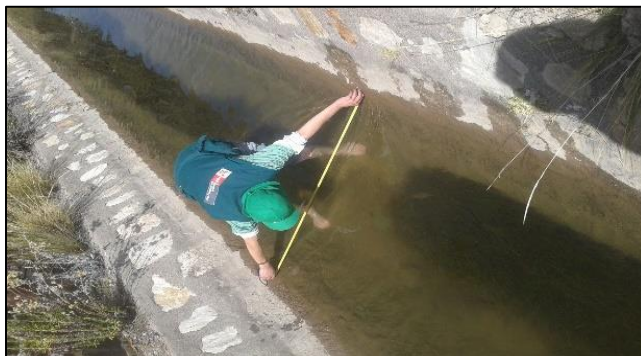
FIGURA 19:Determinación de ancho de cauce
