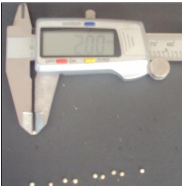
**A:** Regla Vernier para la medición del diámetro de los granos de quinua.
