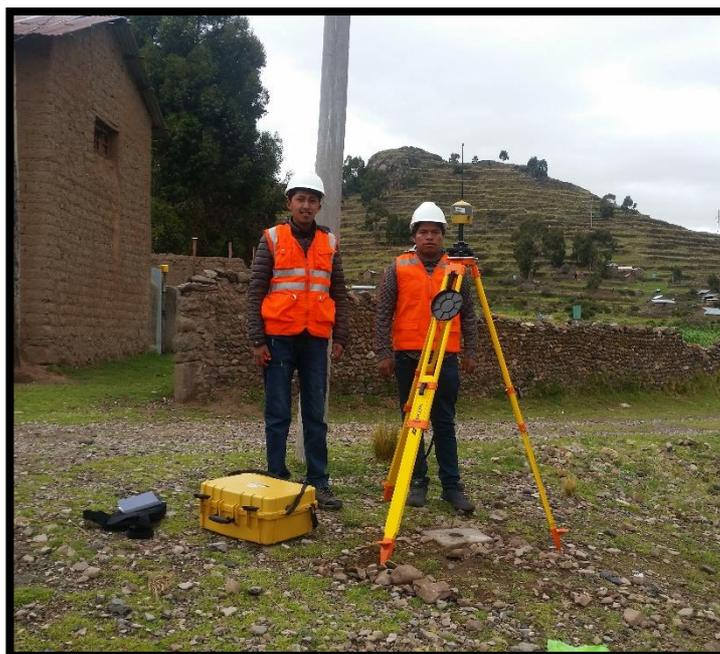
*Figura 45: Posicionamiento y registro de datos del punto EPITA-2
