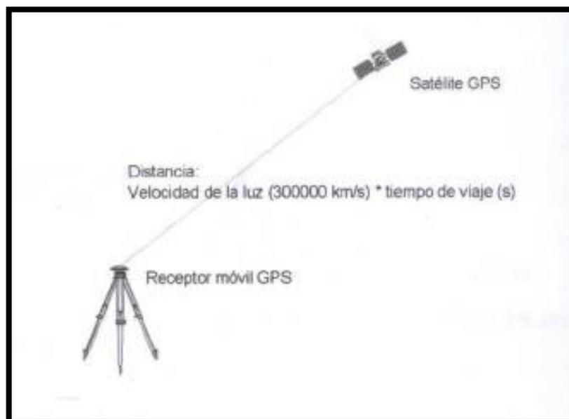
Figura 9: Distancia de un GPS móvil a un satélite.
