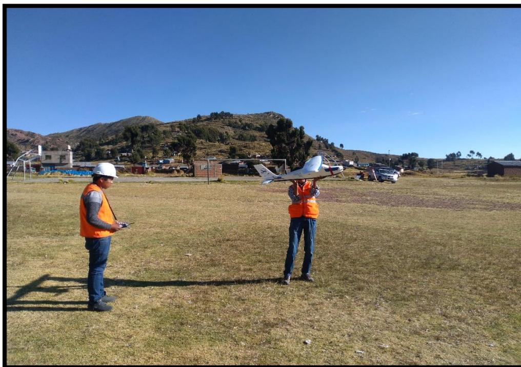
*Figura 62: Drone listo para ser enviado en el primer vuelo a 154 metros de altura.
