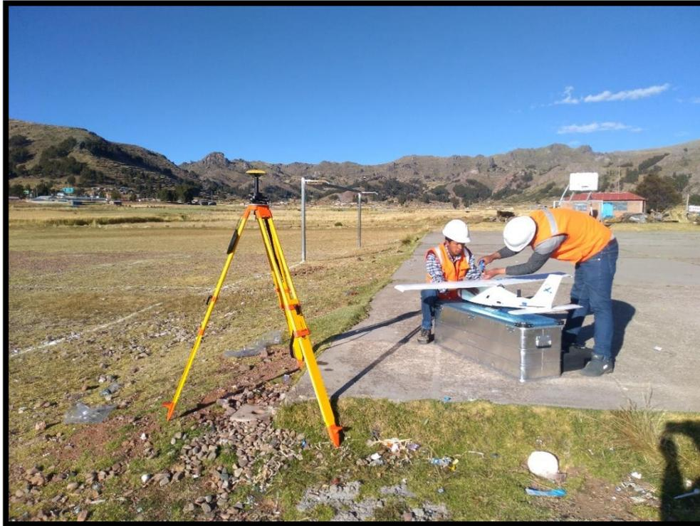
*Figura 60: Instalación de la estación de referencia RTK en el punto EPITA-1 y ensamblaje del drone Topcon Sirius Pro.*
