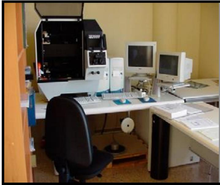
*Figura 19: Restituidor analítico.
