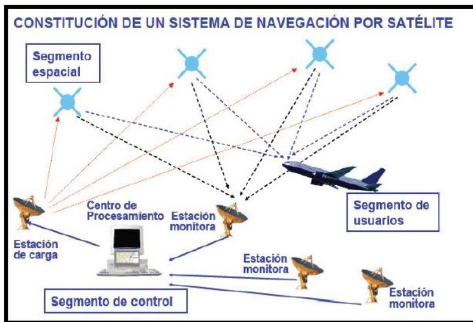
Figura 1 Funcionamiento del GPS.
