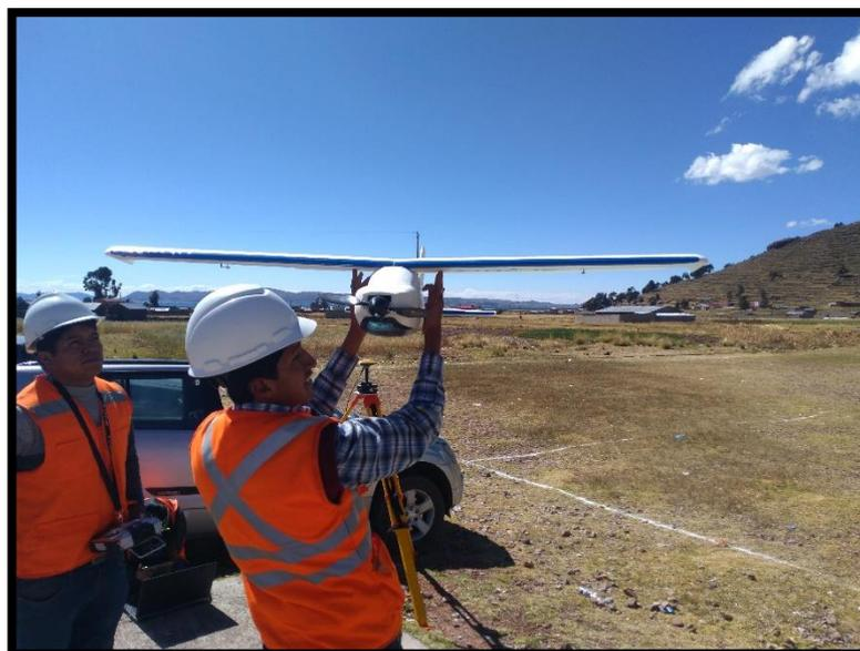
*Figura 64: Prueba de la estabilidad del drone Topcon Sirius Pro*
