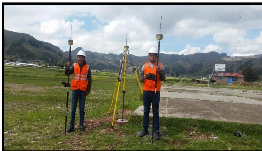
*Figura 54: Base instalada en el punto EPITA-1 y dos rovers Topcon Hiper HR.
