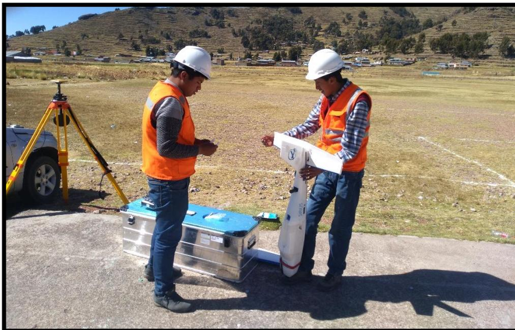
*Figura 63: Instalación de la estación de referencia RTK en el punto EPITA-1 y del drone Topcon Sirius Pro para el segundo vuelo.*
