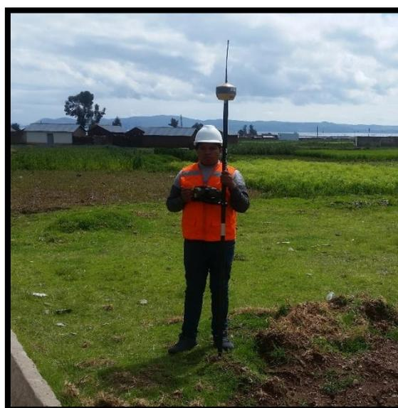
*Figura 55: Inicio de toma de datos de los predios con el sistema GNSS en modo RTK.
