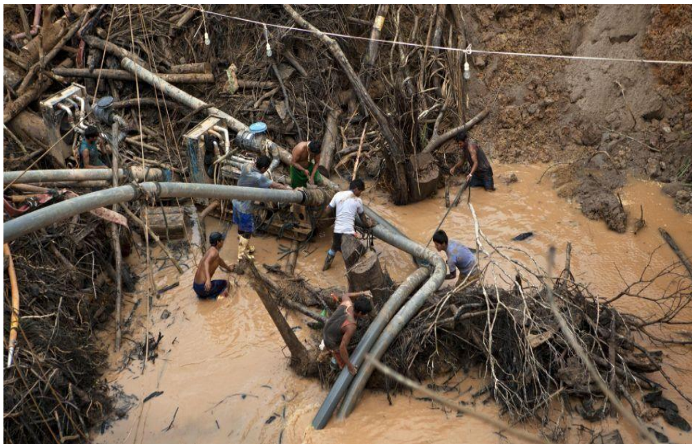
Figura 6. Poza de extracción del material aurífero.
