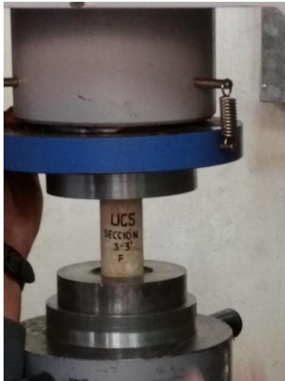
*Figura 3.* Probeta preparada para ensayo de compresión simple.
