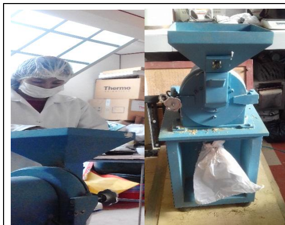
Figuras 3: Molienda con la finalidad de homogenizar el tamaño del material granulado.
