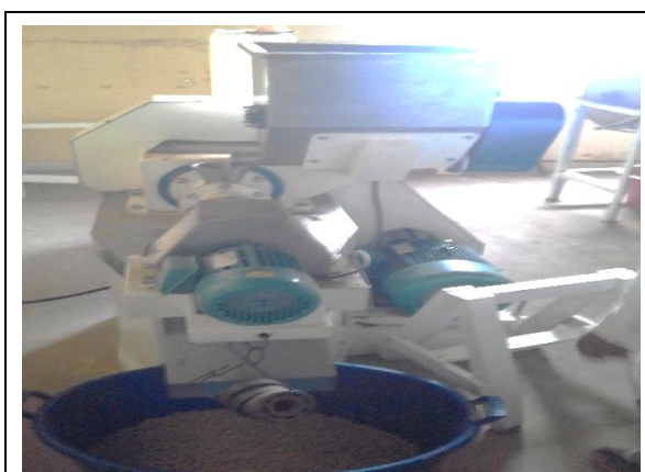
Figuras 8: Peletizado o prensado con alta presión y temperatura para que el pellet sea bien compacto
