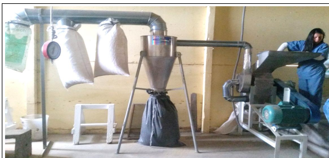
Molienda para homogenizar partículas más pequeñas con el fin de obtener una mezcla más viable para la peletización.
