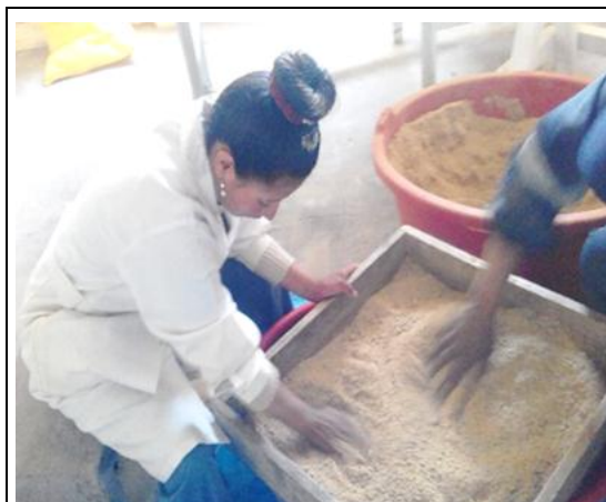
Figuras 7: Tamizado o cribado para retener las partículas de mayor tamaño
