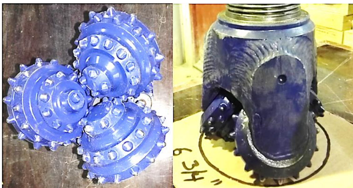
Figura 40. Fotos de broca tricónica TRB 6/34 632.
