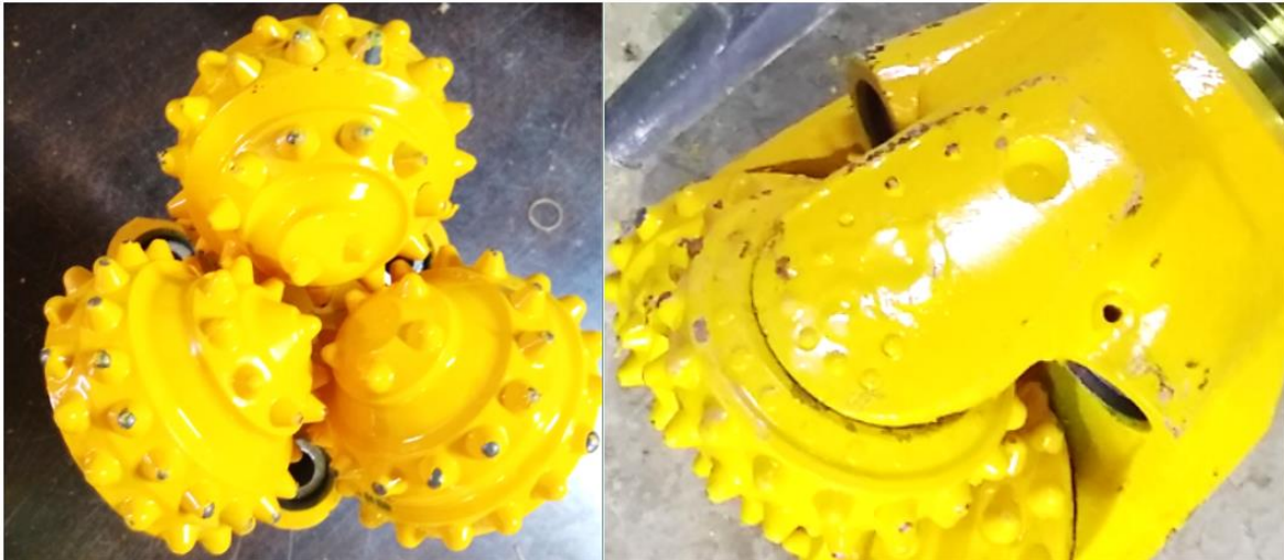
Figura 42. Fotos de broca tricónica WLS 6/34 WLS60 (R278).
