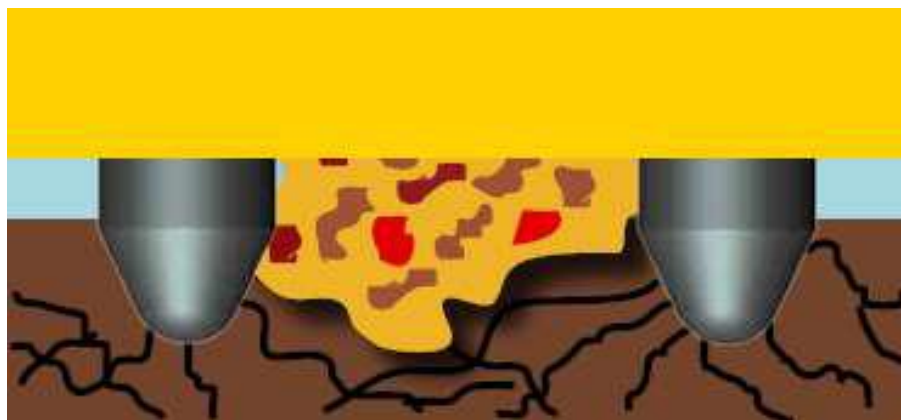
Figura 15. Mecanismo de rotura de roca: Exceso de peso Fuente: Atlas Copco, 2012.
