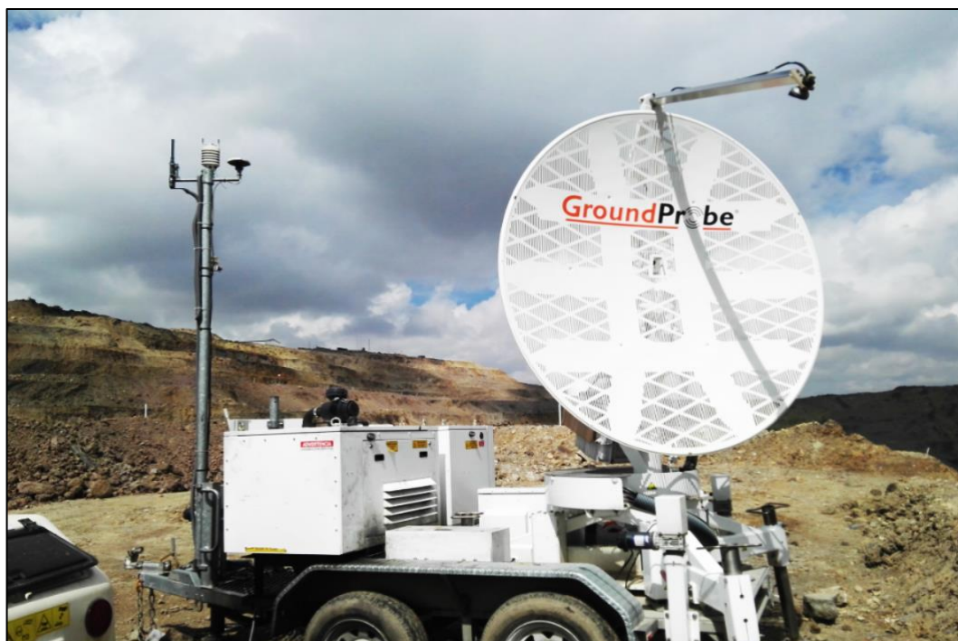
Figura 20. Radar geotécnico GP SSR 313.
