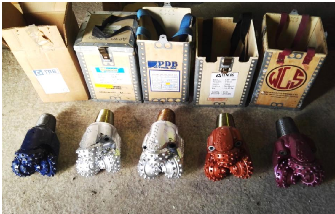
Figura 34. Fotografía de las marcas de broca utilizadas en la prueba.
