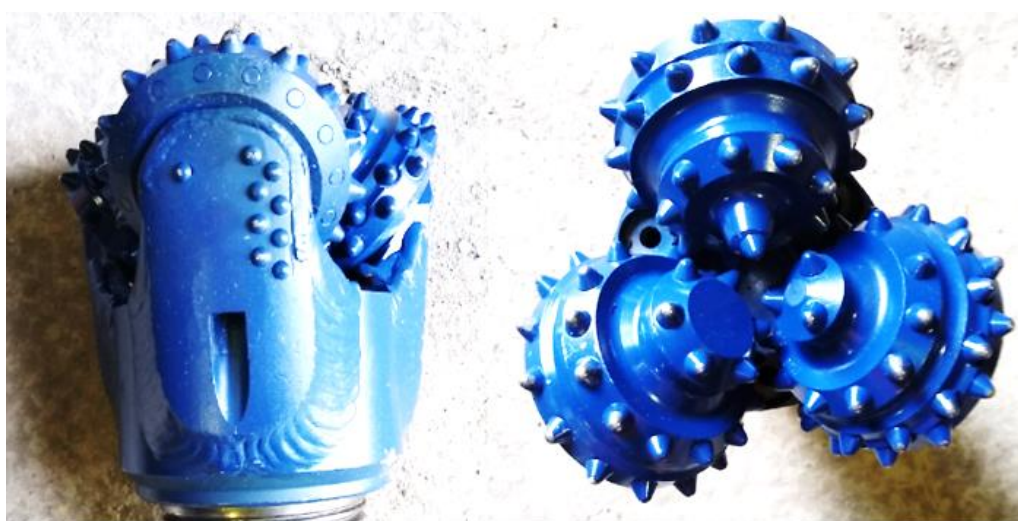
Figura 41. Fotos de broca tricónica TRB 6/34 715.
