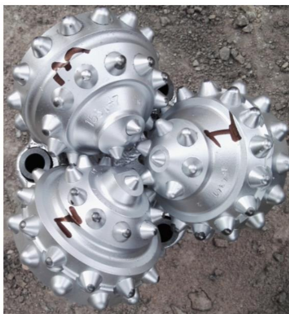
Figura 35. Fotos de broca tricónica PDB GX612
