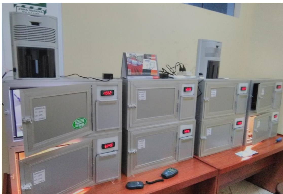
Figura 23. Cámaras para almacenamiento programables para yacon Nota: Tomado en Andahuaylas, de enero a julio del 2018
