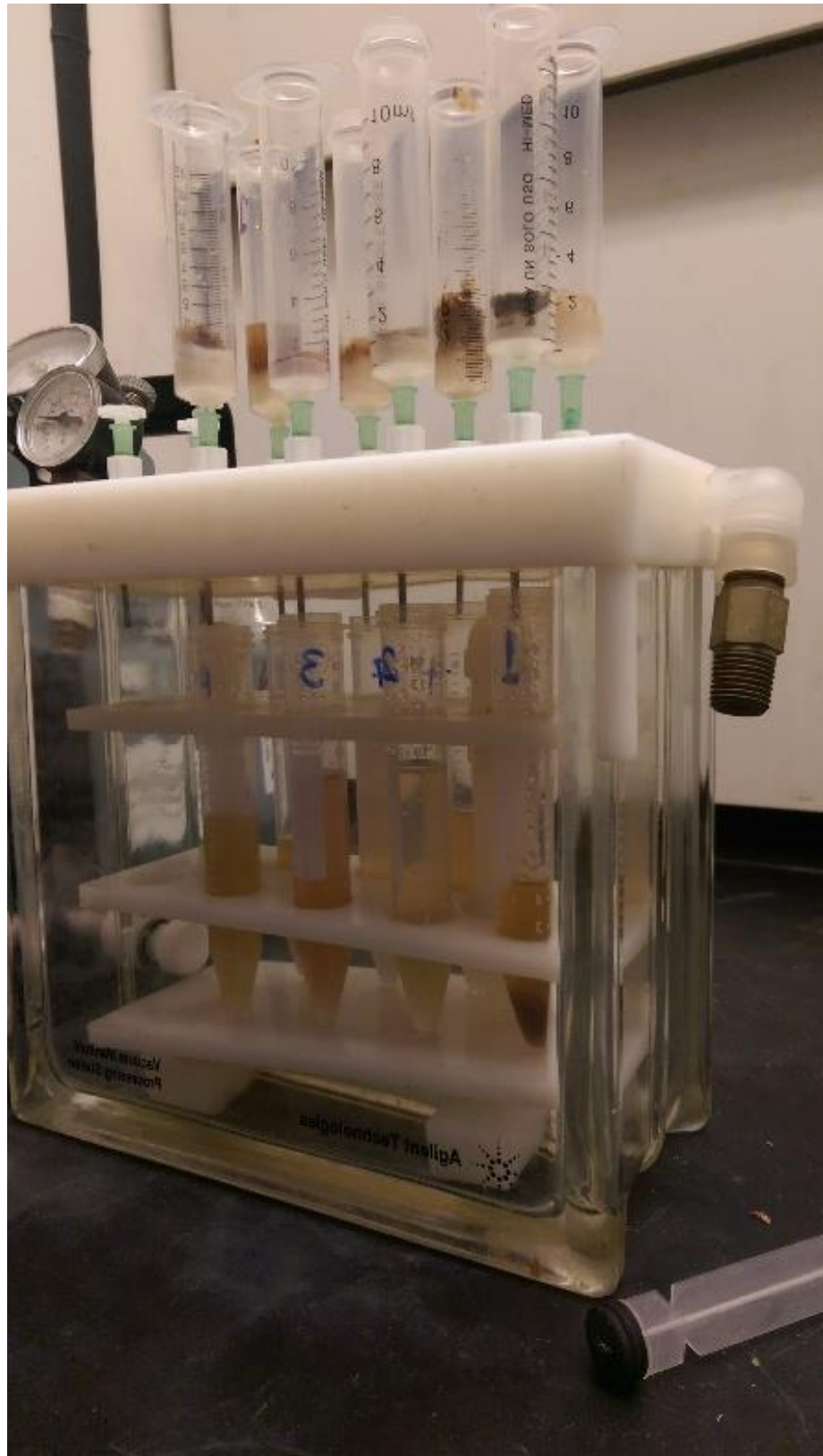
Figura 29. Filtrado de muestras para análisis de FOS e inulina, Nota: Tomado en Andahuaylas, de enero a Julio del 2018.
