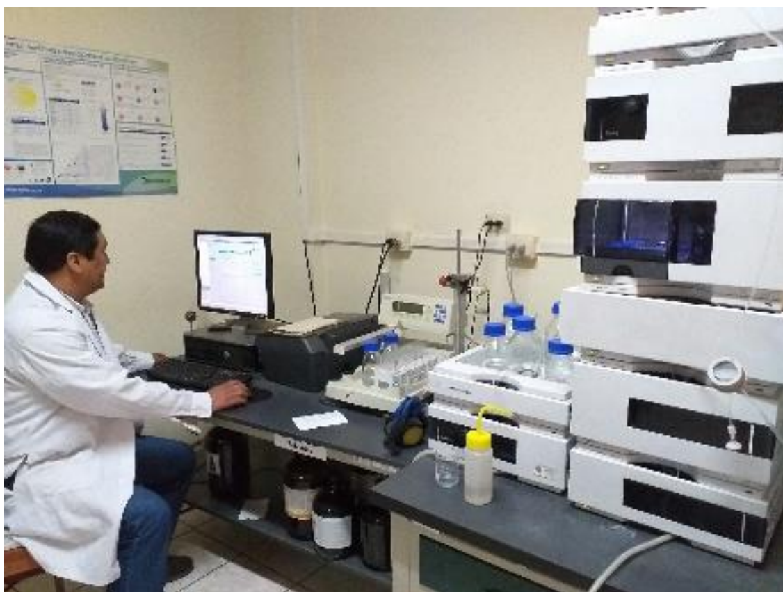
Figura 31. Determinación de FOS e inulina en HPLC Nota: Tomado en Andahuaylas, de enero a Julio del 2018.
