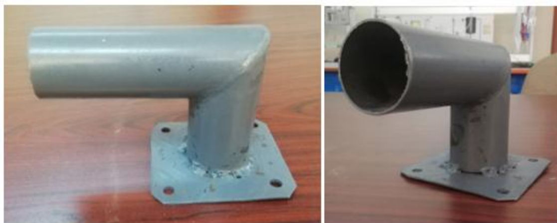
Figura 3 6 - Soporte Diseñado para la antena
