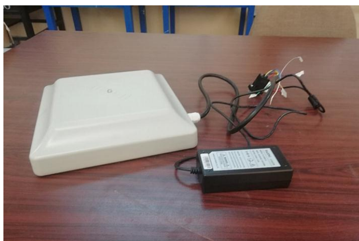
Figura 3 2 - Antena RFID usada en el sistema
