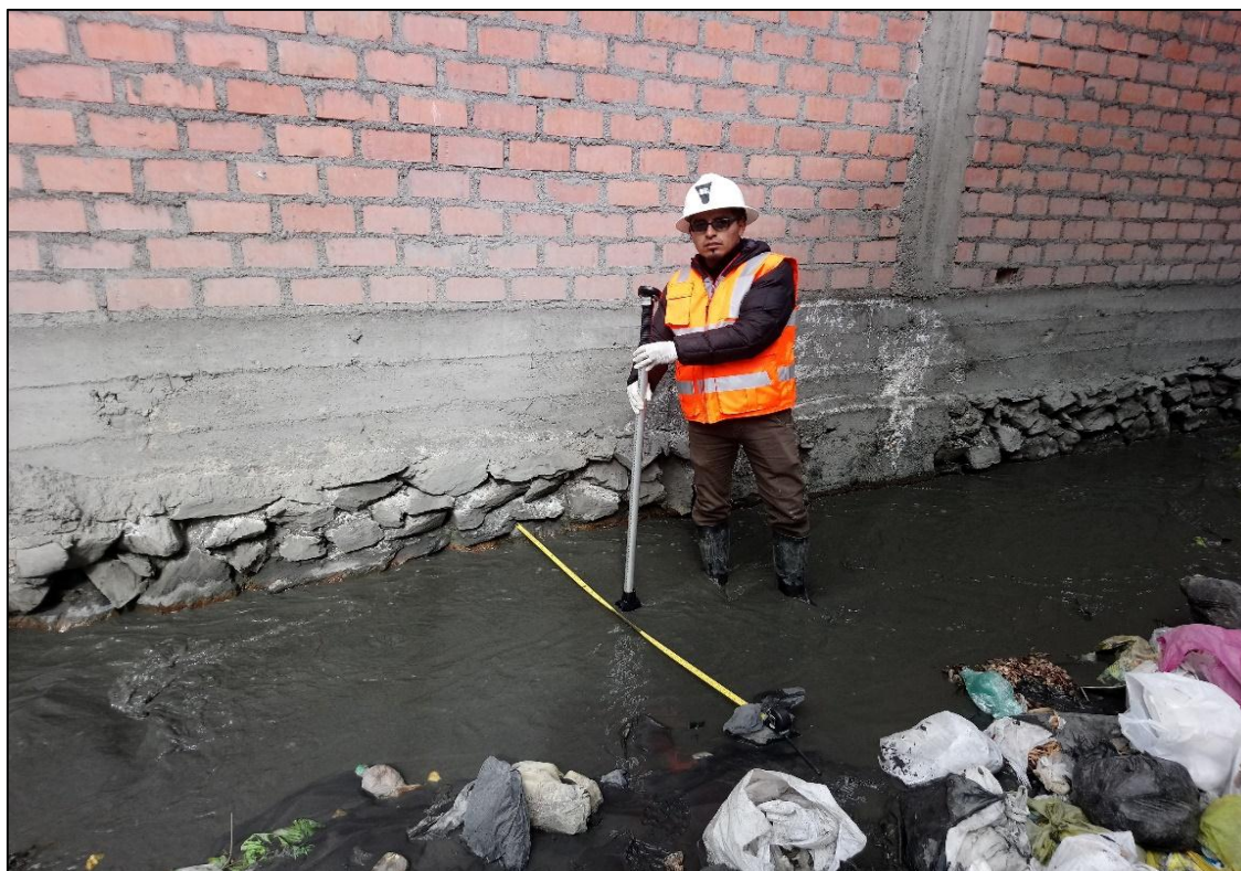
Figura 2: Toma de datos geométricos y determinación de la velocidad de flujo con correntómetro
