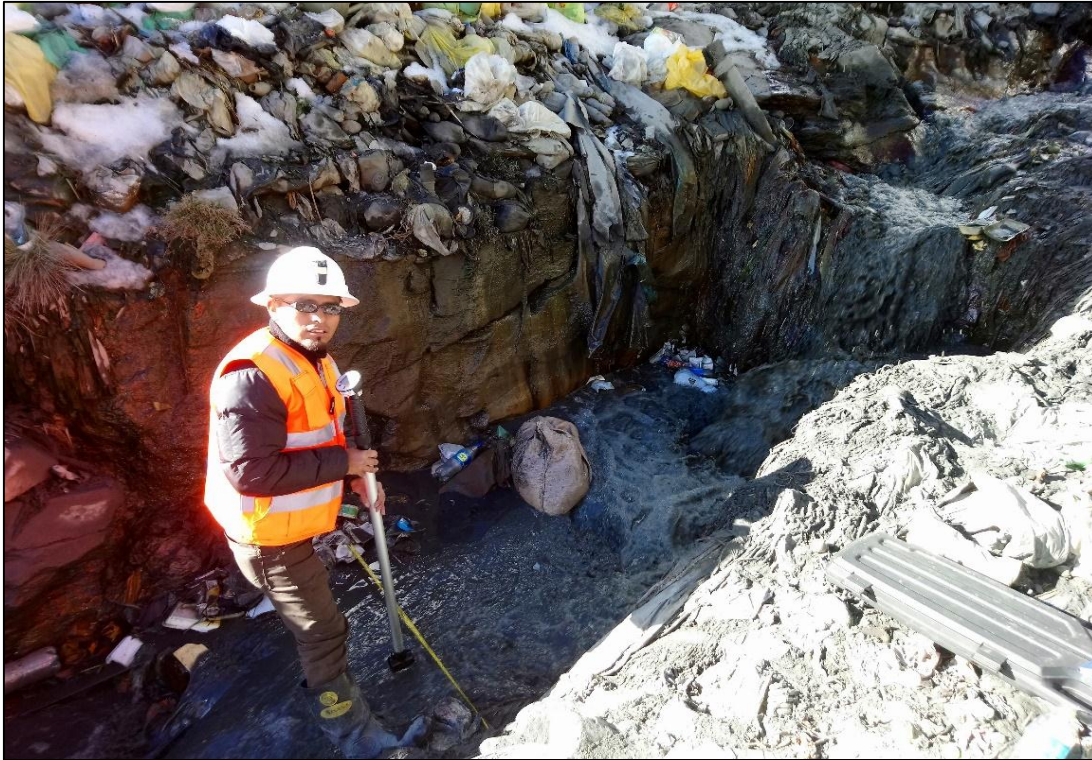
Figura 3: Toma de datos geométricos y determinación de la velocidad de flujo con correntómetro
