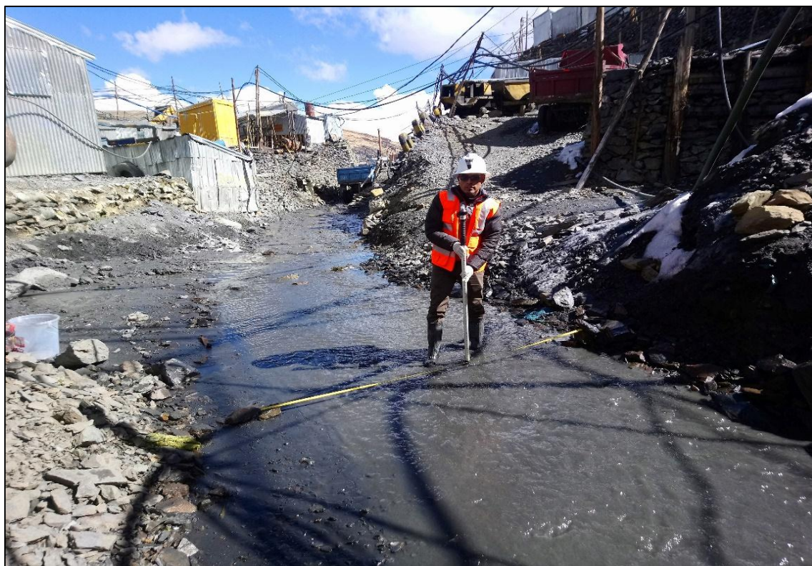
Figura 1: Toma de datos geométricos y determinación de la velocidad de flujo con correntómetro
