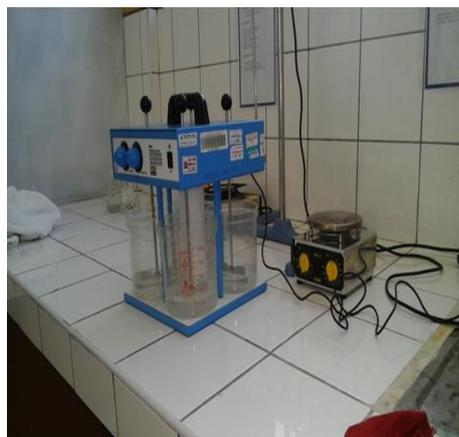
**Figura 4. Instalación experimental para el ensayo coagulación-floculación**
