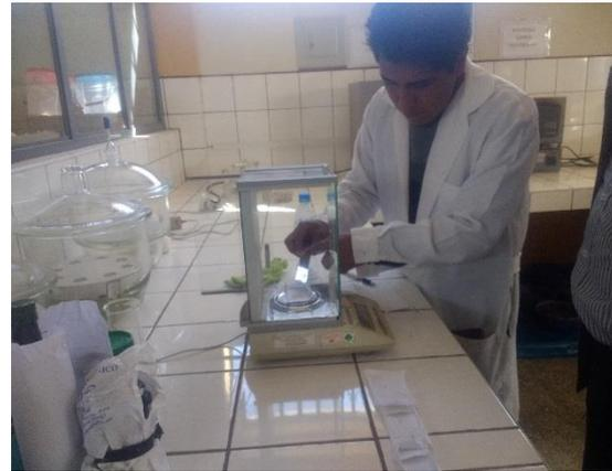
Foto 1. Pesando el coagulante  $Al_2(SO_4)_3$  y el floculante  $Ca(OH)_2$
