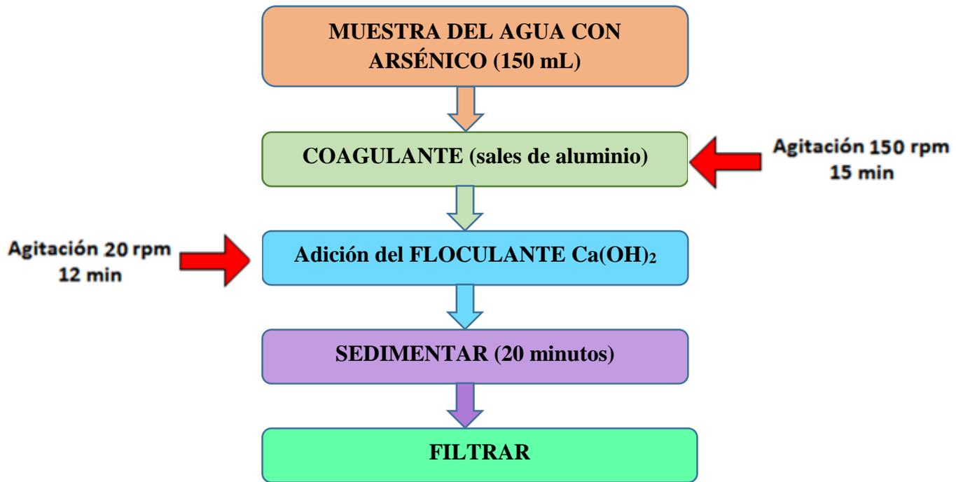
**Figura 5. Diagrama de flujo de la prueba Coagulación-Floculación para Aguas Municipales y**
