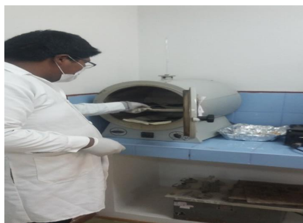
Figura 17: Colocado de las muestras de lodos en la mufla para su secado.
