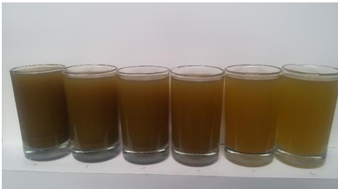
Figura 26. Comparación visual de los SST, tratamiento 03: T0 con T1, T2, T3, T4 y T5, de las aguas residuales verdes, del centro de beneficio animal Azoguini (noviembre 2018 a agosto 2019)
