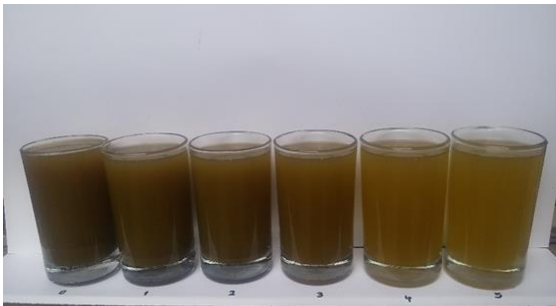
Figura 24. Reducción visual de los SST, tratamiento 01: T0 con T1, T2, T3, T4 y T5, de las aguas residuales verdes, del centro de beneficio animal Azoguini (noviembre 2018 a agosto 2019)
