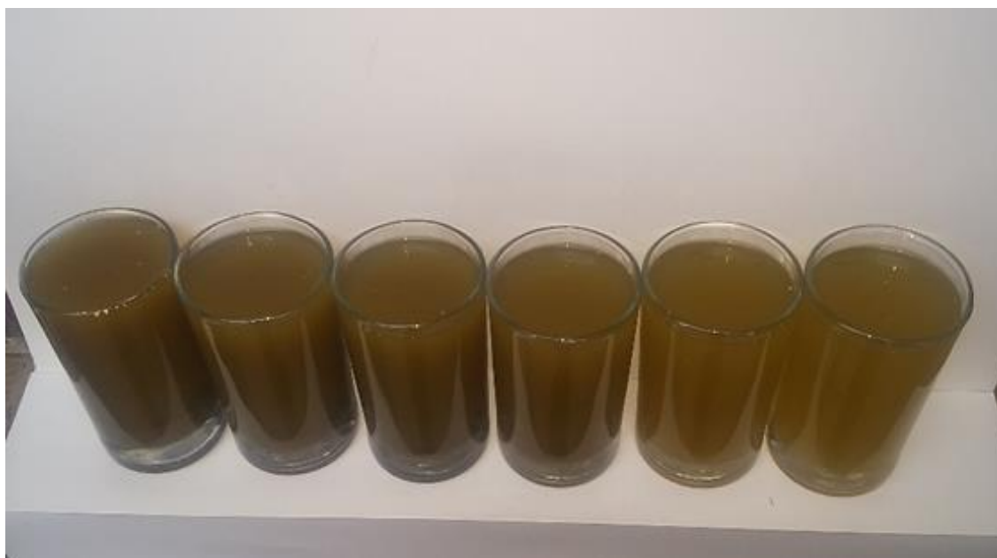
Figura 25. Reducción visual de los SST, tratamiento 02: T0 con T1, T2, T3, T4 y T5, de las aguas residuales verdes, del centro de beneficio animal Azoguini (noviembre 2018 a agosto 2019)
