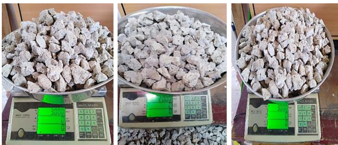
Figura 22. Pesado de piedra pómez para las distintas repeticiones, en el laboratorio de mecánica de suelos y rocas de la EPI- UNAP
