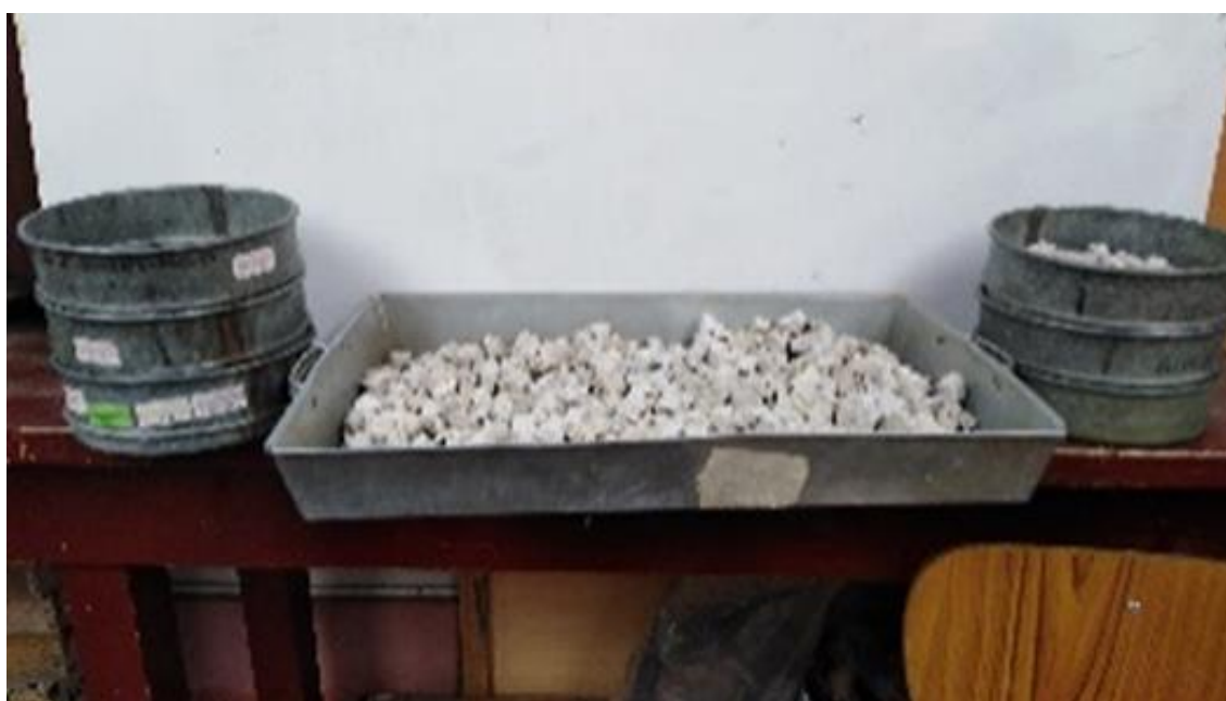
Figura 20. Preparación de los filtros de piedra pómez, en el laboratorio de mecánica de suelos y rocas de la EPIG - UNAP
